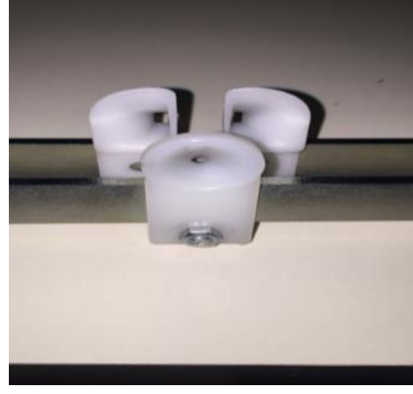
Şekil 2.7 Üçlü fitil hunisi yerleşimi
