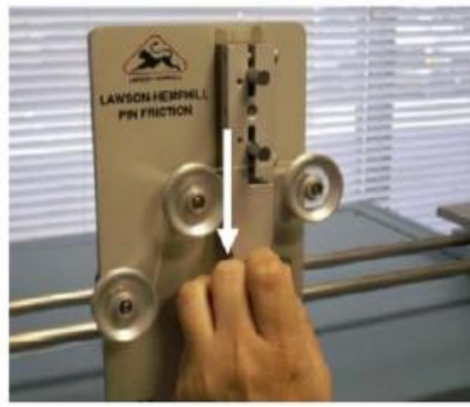
Şekil 2.12 İplik-materyal sürtünmesi testi öncesi ipliğin konumu (Lawson Hemphill CTT, 2008).
