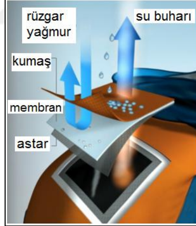
Şekil 1.13 Su geçirmez nefes alabilen bir kumaş yapısı (Waterproof breathable fabric, 2014)
