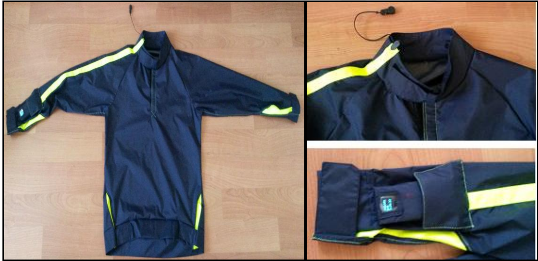
Şekil 3.51 Elektronik ekipmanlı yelken giysisi (sol: tüm giysi, sağ üst: yaka kısmı ve nabız sensörü, sağ alt: kol kısmı ve uydu sistemin yerleştirildiği su geçirmez cep)
