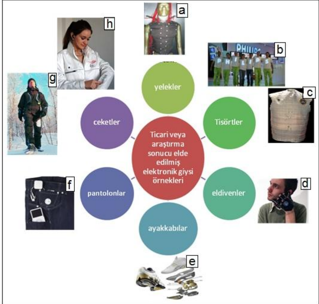
Şekil 1.14 Elektronik fonksiyona sahip tekstil ürünleri örnekleri (a) Isıtıcı yelek (Şahin, Kayacan ve Bulgun, 2006) (b) LED (Işık yayıcı diot) entegre edilmiş tişört (Harold, 2006) (c) Giyilebilir anakart (Georgia Tech Wearable Motherboard, b.t.) (d) Akıllı eldiven (Glove One, b.t.) (e) Akıllı ayakkabı (Adidas 1, b.t.) (f) Ipod jean (Ipod compatible jeans, 2006) (g) Kuzey kutbunda giyilmek üzere geliştirilen giysi (Rantanen ve ark., 2002) (h)The Know Where Jacket (Weir, 2007b)
