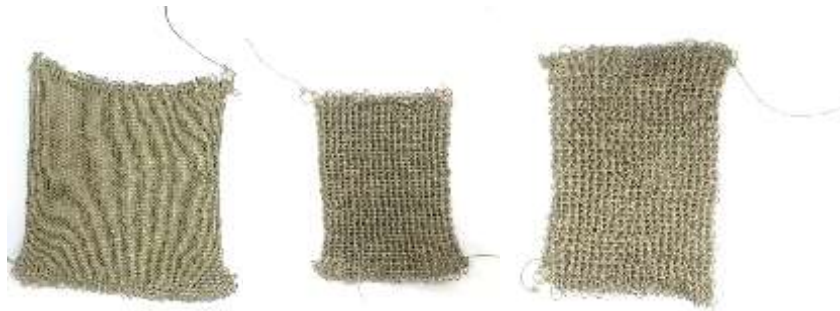
Şekil 3 1 Statex Shieldex iplik kullanılarak üretilen elektrotlara ait örnek görüntüler (Kişisel arşiv, 2017)
