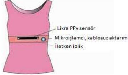
Şekil 1.41 Kumaş esneme sensörü kullanılarak esneme oranını ölçebilen tişört (Coyle ve ark., 2009)
