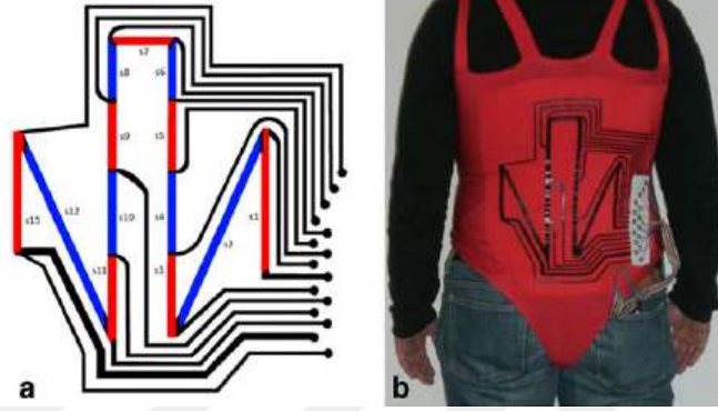
Şekil 1.46 a) Karbon elastomer gerginlik sensörlerinin giysi prototipi üzerindeki yerleşim düzeni. Kalın çizgiler sensörler, ince çizgiler aynı polimerden yapılmış bağlantı kablolarıdır. b) giysinin arkadan görünümü. (Tormene ve ark., 2012)
