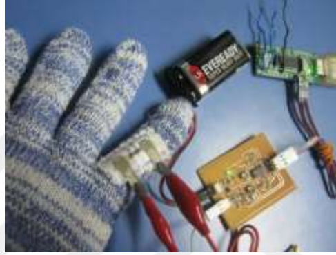
Şekil 1.48 İşaret parmağı üzerine sensör ünitesi dikilmiş eldiven prototipi (Yuen ve ark., 2014)
