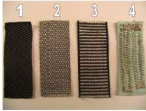
Şekil 1.15 Farklı üretim teknikleri kullanılarak üretilen tekstil elektrotları (Pola ve Vanhala,2007)
