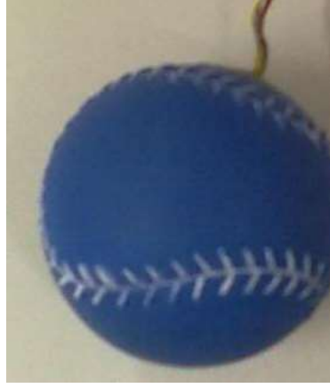
Şekil 1.36 İçerisine basınç sensörü yerleştirilmiş topun görüntüsü (Mohan ve ark., 2013)
