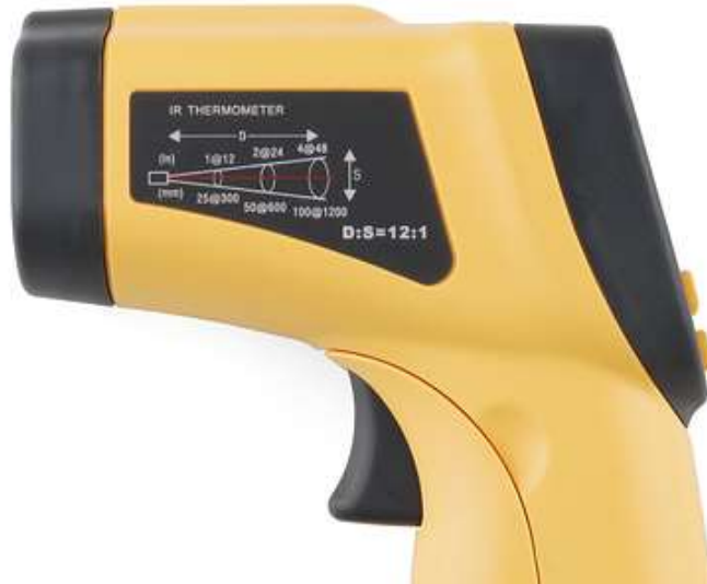
Şekil 2.5 İnfrared termometre üzerinde bulunan, ölçüm uzaklığı ayarını gösteren şema (Kişisel arşiv, 2017)
