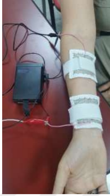
Şekil 3.2 Tekstil elektrotları kullanılarak denekler üzerinde gerçekleştirilen denemelere örnek (Kişisel arşiv, 2016)
