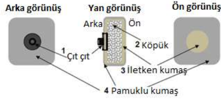
Şekil 1.22 Çalışmada kullanılan tekstil elektrotlarının şematik yapısı (Löfhede ve ark., 2012)
