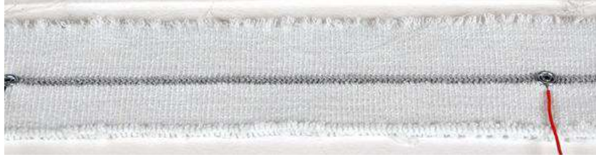
Şekil 1.43 İletken ipliklerle yapılmış örme gerginlik sensörü (Guo ve ark., 2011)
