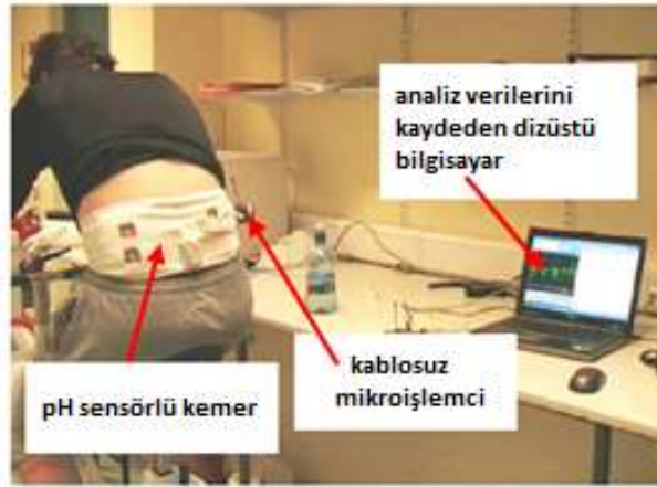
řekil 1.40 Ter pH sensr iin deney dzeneęi (Coyle ve ark., 2009)
