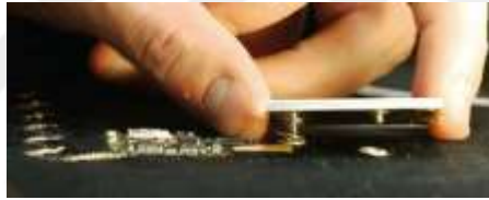
Şekil 1.11 Düz batarya ve çitçit bağlantıları (Linz ve ark., 2006)
