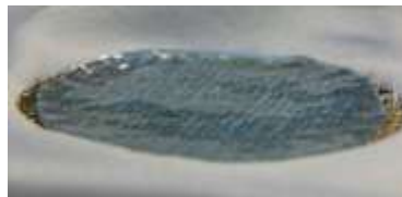
Şekil 1.12 Katı jel pedi ile kaplı nakışla işlenmiş elektrot 0 (Linz ve ark., 2006)
