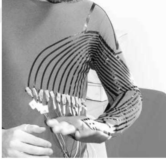
Şekil 1.26 İletken elastomerler kullanılarak elde edilen algılama şeritleri ve bağlantı kabloları (Giorgino ve ark., 2006)
