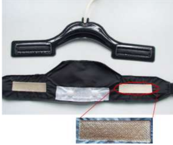
Şekil 1.23 Nemlendirme pedi prototipi (üstte) ve nakışla işlenmiş elektrotlara sahip EKG bandı (Weder ve ark., 2015)
