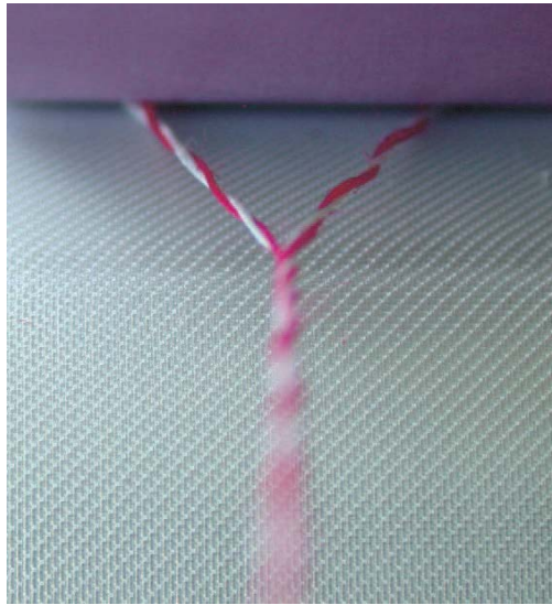
Şekil 1.20 İplik katlama işlemi ve katlı iplik (Brunk, 2004)
