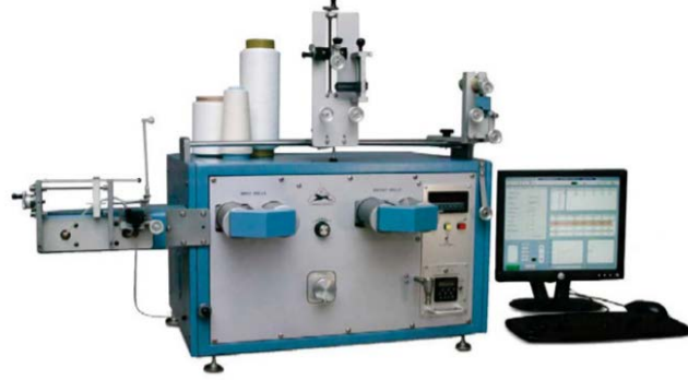
Şekil 2.19 Lawson Hemphill CTT dinamik sürtünme test cihazı (Lawson Hemphill, 2017)
