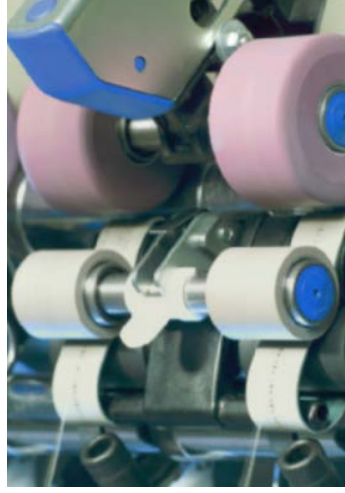
Şekil 1.15 Ring iplik makinesinde çekim bölgesi (Oerlikon Schlafhorst, 2009)
