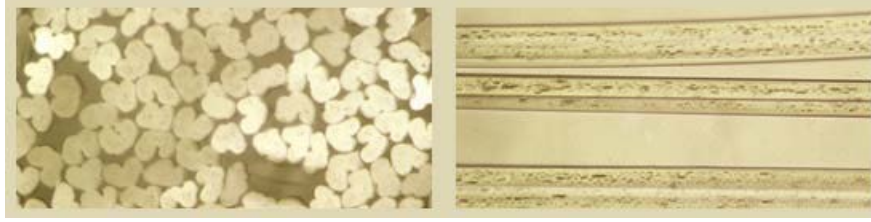
Şekil 2.8 1,3dtex Modal lifinin enine kesit ve uzunluğuna görünüşleri (Balcı Kılıç, 2016)
