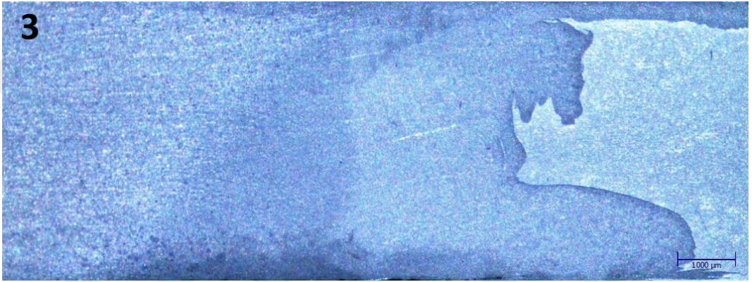
Şekil 4.2 TDH=800 d/d, TİH=50 mm/d parametrelerine sahip numunenin makroskobik görüntüsü
