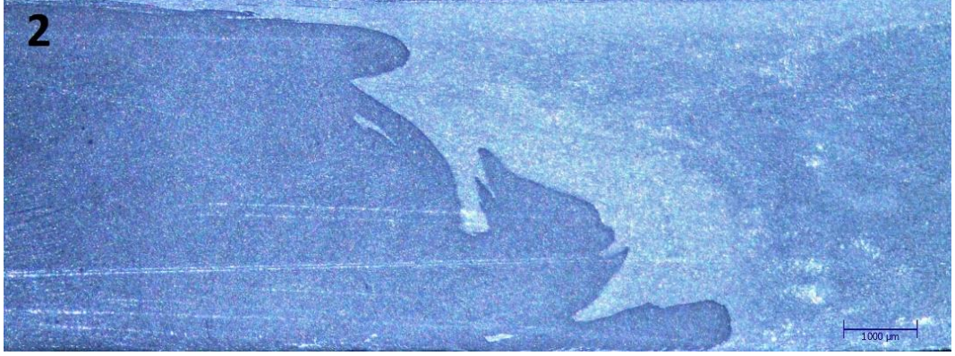
Şekil 4.1 TDH=630 d/d, TİH=50 mm/d parametrelerine sahip numunenin makroskobik görüntüsü
