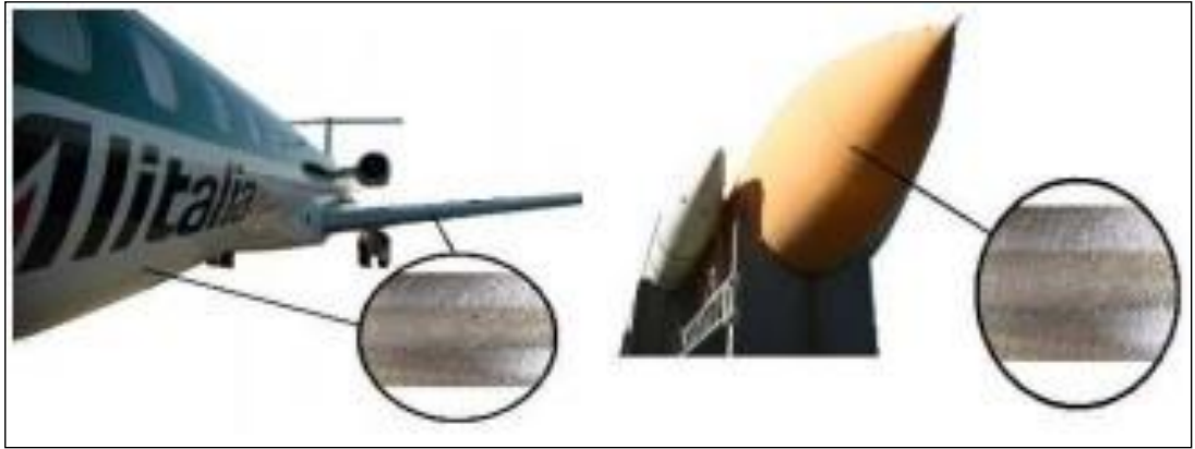
Şekil 2.3 Uçak gövdesi ve roket yakıt tanklarında SKK kullanımı (TWI, bt)
