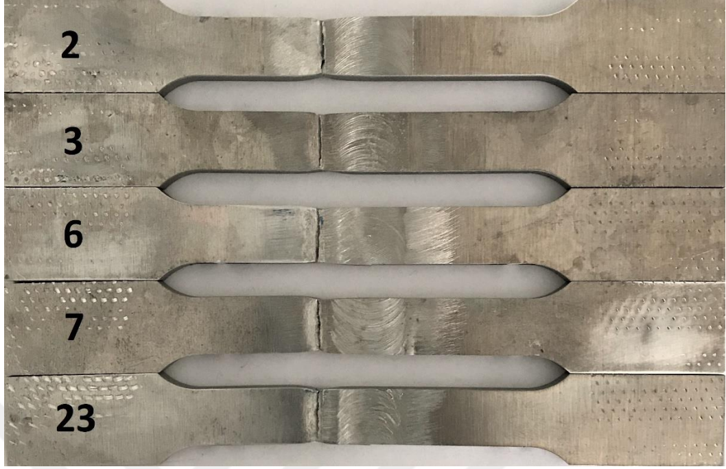
Şekil 4.33 Çekme testi sonrası numunelerin kopma yerleri (Üçgen pim) (Kişisel Arşiv, 2017)
