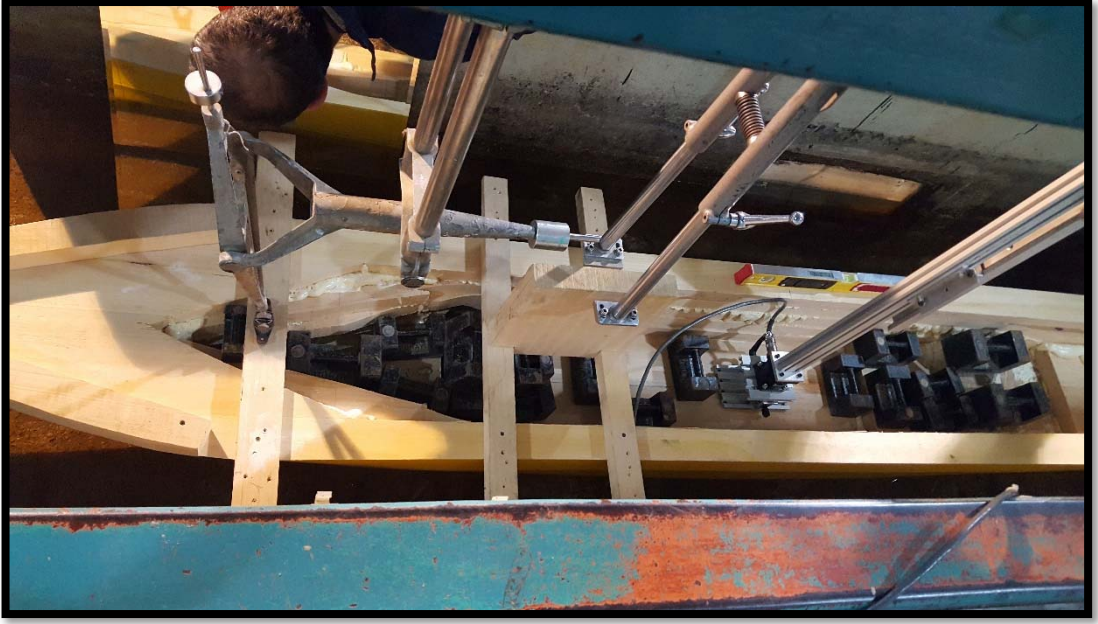
Şekil 4.11 Ağırlıklar ve su terazisi ile deney koşullarının sağlanması (Kişisel arşiv, 2017)
