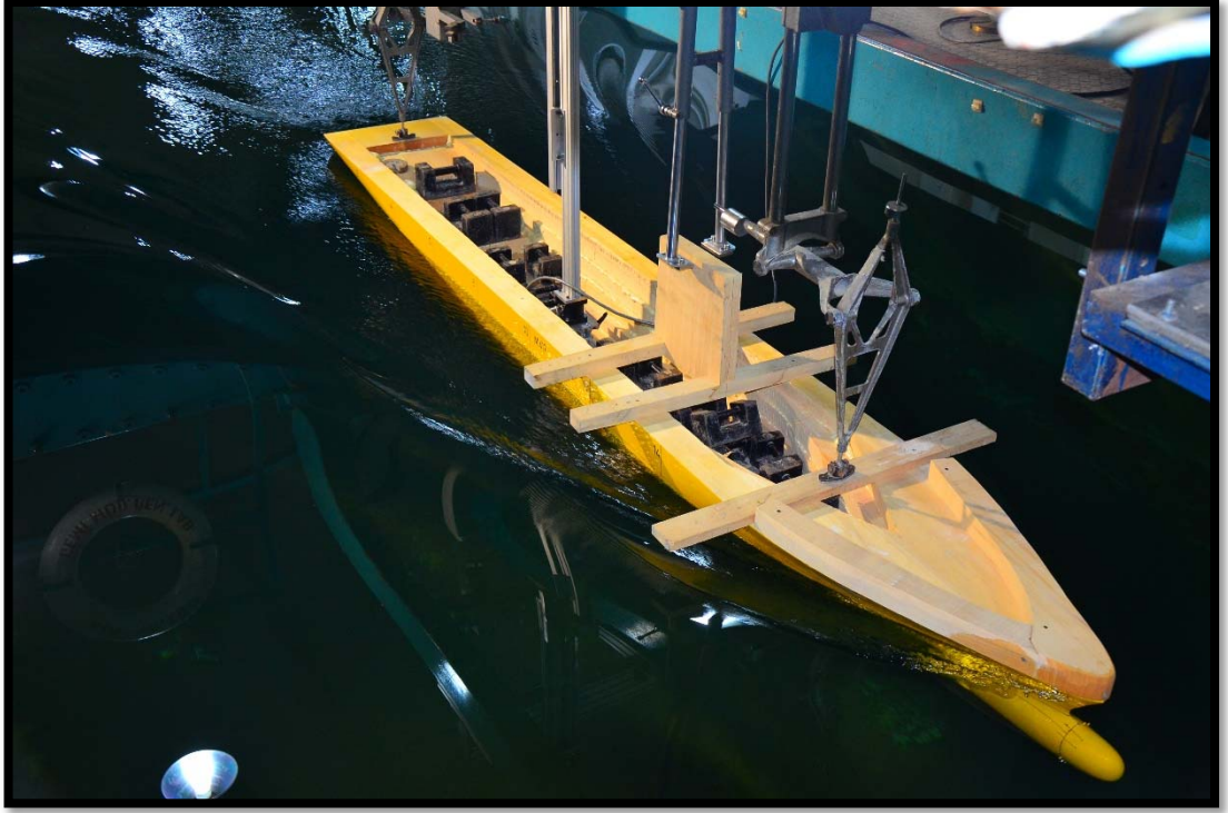
Şekil 4.12 Gemi modelinin çekme arabası ile çekilmesi (Kişisel arşiv, 2017)
