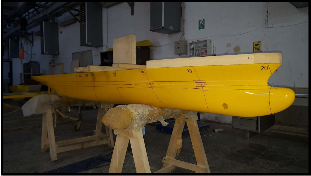
Şekil 4.10 Trim ve Deplasman koşulları belirlenen 1/58 ölçekli gemi modeli (Kişisel arşiv, 2017)
