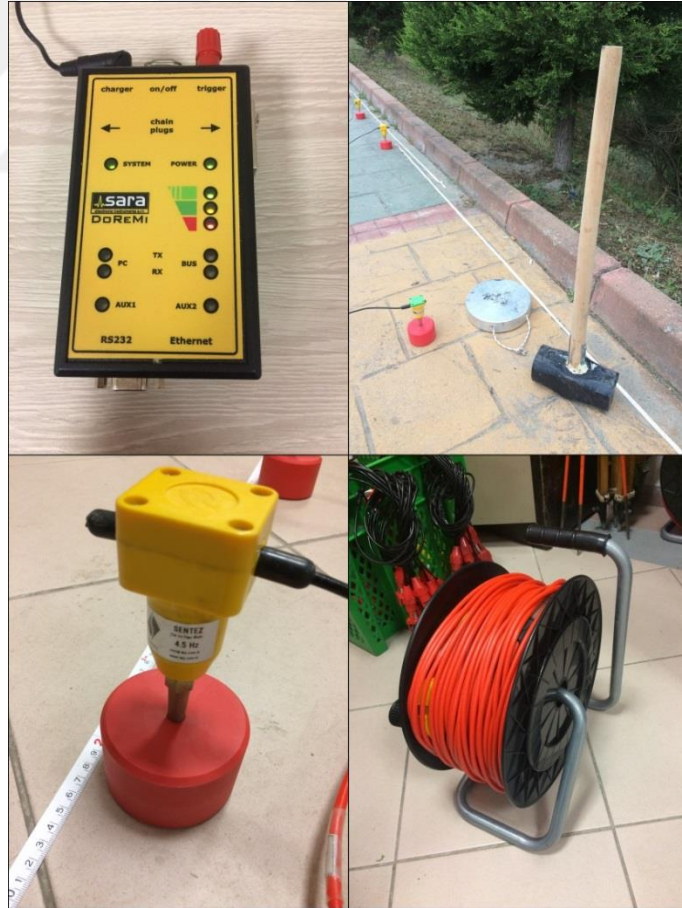
Şekil 3.2 Sismik kayıt cihazı (sol-üst), Tetikleme-Plaka-Balyoz (Sağ-Üst), 4,5 Hz Jeofon (sol-alt), Sismik kablo (sağ-alt) (Kişisel arşiv, 2018)
