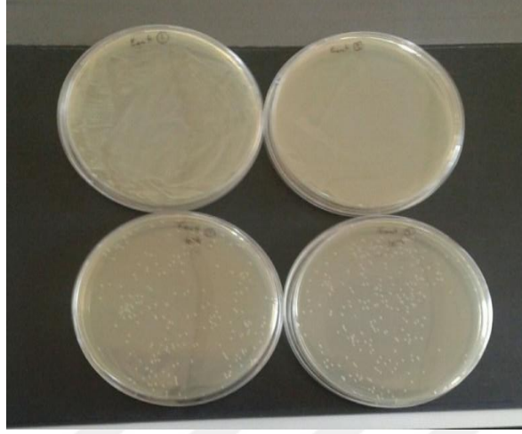
Şekil 3.28 Metal oksit içermeyen kontrol numunesi ile yapılan antibakteriyellik testine ait petri fotoğrafları
