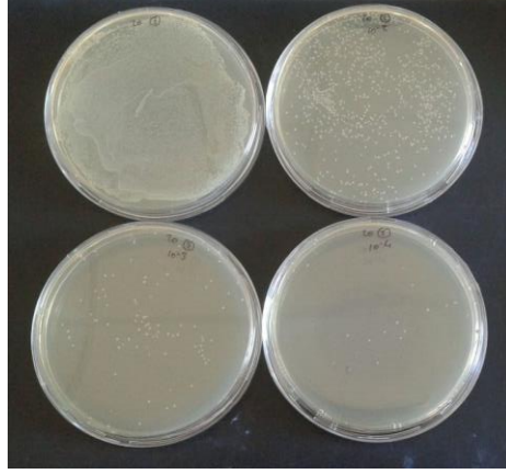
Şekil 3.23 %20 çinko oksit içeren numune ile yapılan antibakteriyellik testine ait petri fotoğrafları
