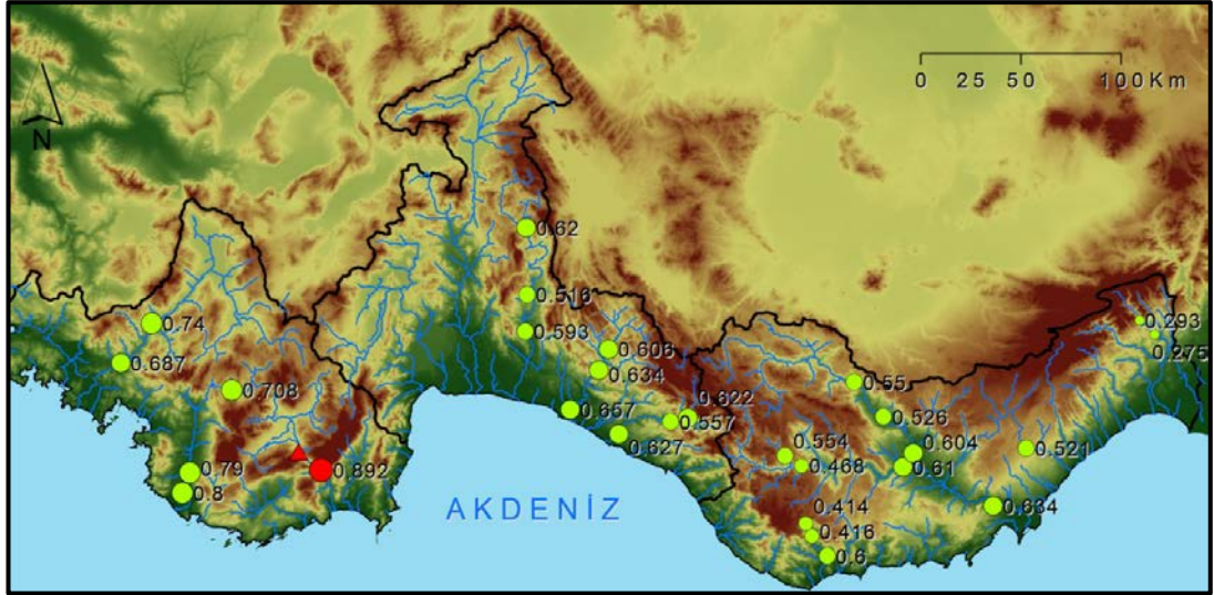
Şekil 5.29 Avlan Gölü sulak alanına tahsis edilen ve üçgen ile gösterilen sanal istasyon 2 için diğer mevcut istasyonlarla karşılıklı hesaplanan korelasyon katsayıları (En yüksek korelasyon katsayısı 0,892 değeri 808 nolu istasyon ile hesaplanmıştır.)
