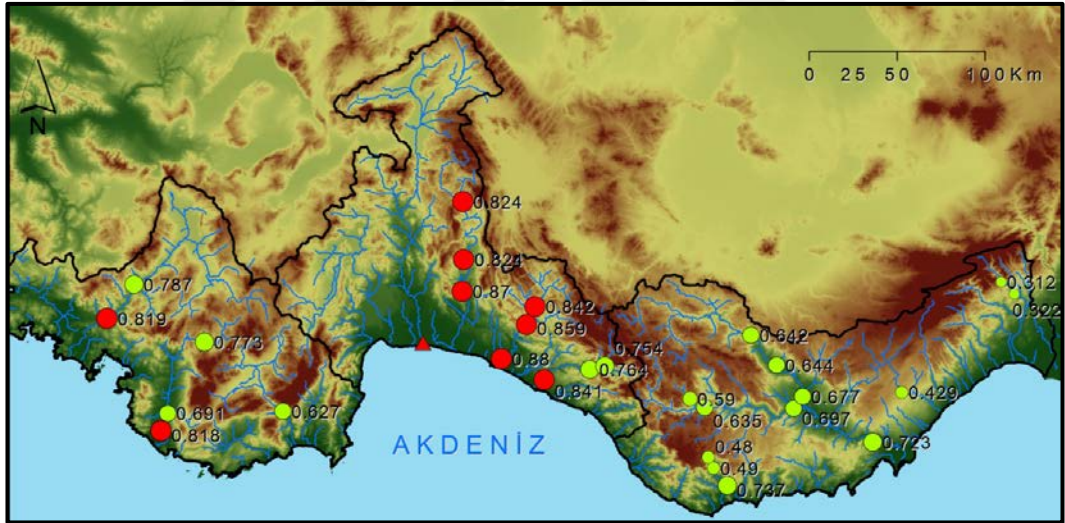
Şekil 5.33 Aksu Deltası sulak alanına tahsis edilen ve üçgen ile gösterilen sanal istasyon 10 için diğer mevcut istasyonlarla karşılıklı hesaplanan korelasyon katsayıları (En yüksek korelasyon katsayısı 0,88 değeri 918 nolu istasyon ile hesaplanmıştır.)
