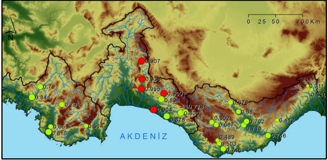
Şekil 5.32 Köprüçay (Olukköprü Kaynakları) sulak alanına tahsis edilen ve üçgen ile gösterilen sanal istasyon 9 için diğer mevcut istasyonlarla karşılıklı hesaplanan korelasyon katsayıları (En yüksek korelasyon katsayısı 0,955 değeri 902 nolu istasyon ile hesaplanmıştır.)
