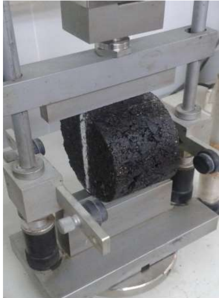
Şekil 4.25 Sıkıştırılmış numunenin indirekt çekme dayanımı ölçümü için cihaza yerleştirilmesi (Kişisel arşiv, 2017)
