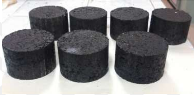
Şekil 4.23 Marshall tasarım yöntemine göre hazırlanmış asfalt numuneleri (Kişisel arşiv, 2017)
