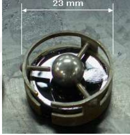
řekil 4.9 Yumuřama noktası örneęi (pirinç halkaya yerleřtirilerek üzere çelik bilye konulmuř) (Pavement Interactive, 2012b)
