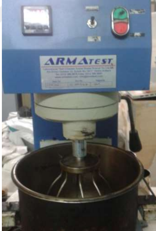
Şekil 4.21 Bitüm ve agregayı karıştırmak için kullanılan karıştırıcı (Kişisel arşiv, 2017)
