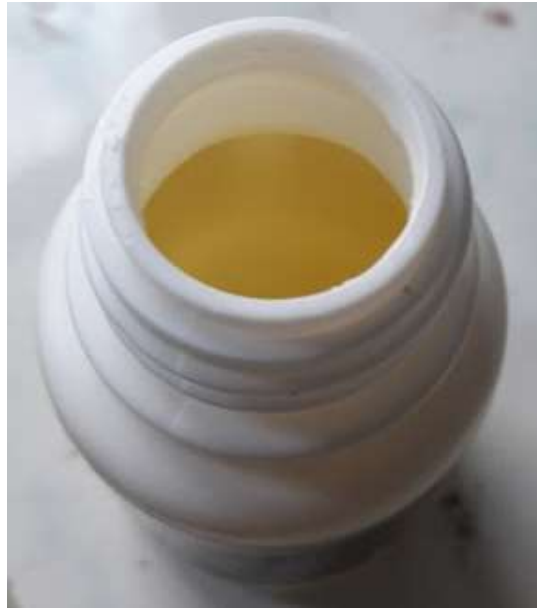
Şekil 4.3 Nano-organosilan (ZycoTherm®) soyulma önleyici katkı (Kişisel arşiv, 2017)
