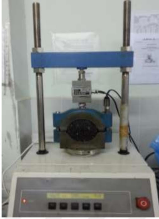
Şekil 4.20 Marshall stabilite deney cihazı (Kişisel arşiv, 2017)
