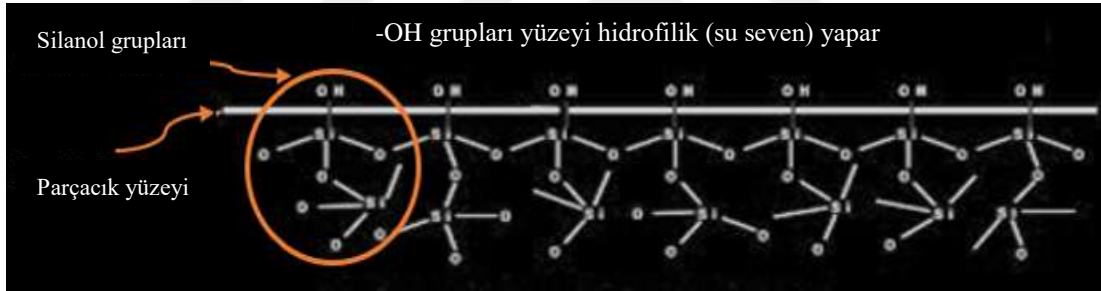
Şekil 3.6 Nano-organosilan ilavesinden önce hidrofilik agrega yüzeyi (su seven) (Zydex, 2013)
