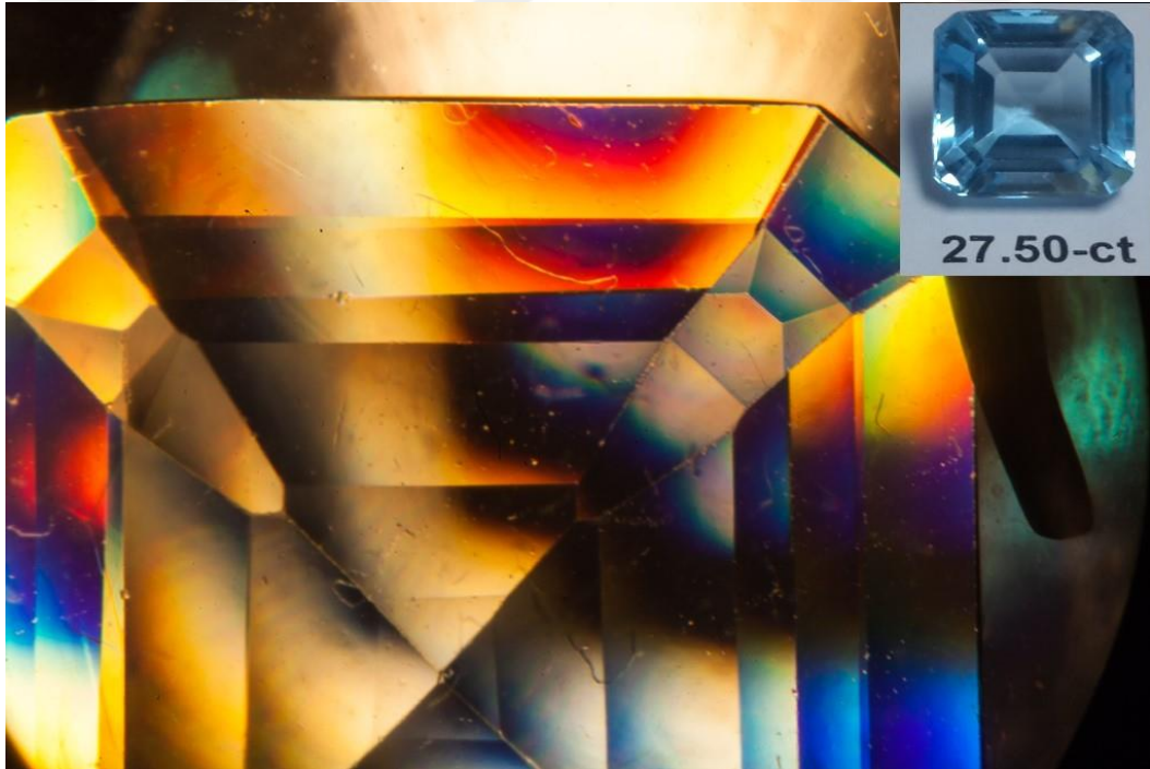
Şekil 3.38 Doğal oluşumlu ancak radyasyon tedavisi görmüş, işlenmiş, gökyüzü mavisi renkli topaz örneğinin (27,50-ct ağırlığında), İmmersiyonoskop resmi (Kişisel arşiv, 2018)
