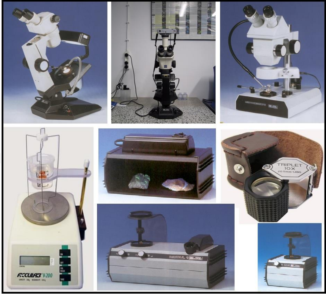
Şekil 2.5 Bu çalışma kapsamında kullanılan bazı temel gemolojik aletler (x10 büyütme lup, polariskop, refraktometre, hidrostatik terazi, diaskop, gemmoskop, UV-lamba) (Kişisel arşiv, 2018)
