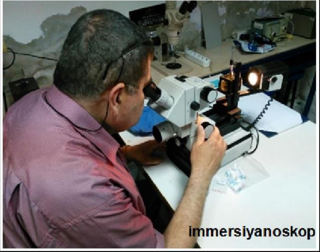
Şekil 2.8 İmmersiyonoskop cihazı [Özellikle renk tedavili topazların incelemesinde ve fotoğraflarının alınmasında kullanılmıştır] (Kişisel arşiv, 2018)
