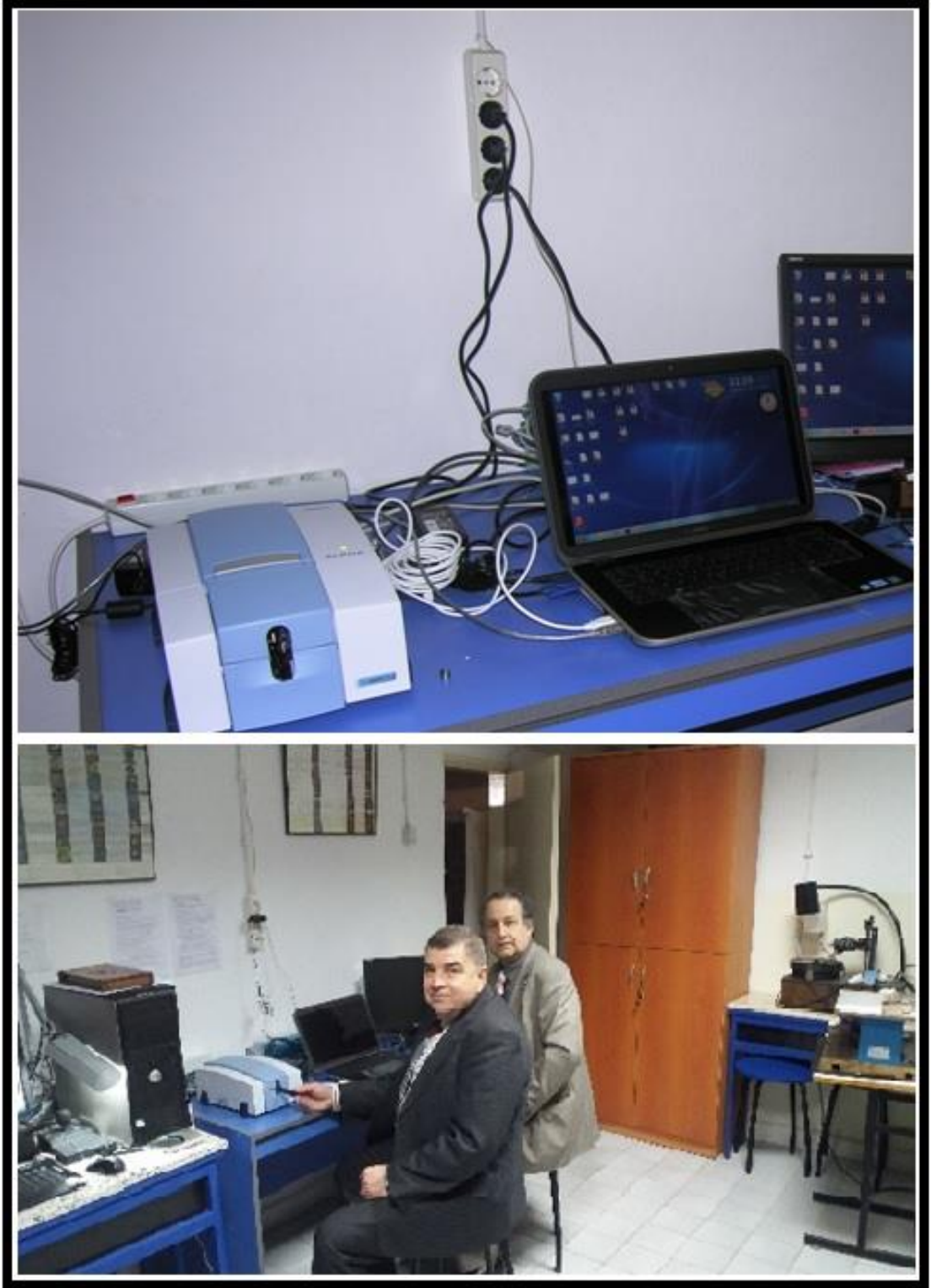
Şekil 2.7 Fourier Transform Infrared (FT-IR) cihazı [Renk verici elementlerin belirlenmesinde kullanılmıştır] (Kişisel arşiv, 2018)
