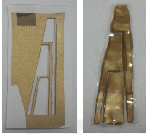
Şekil 4.11 Yapısal iyileştirme sonucu elde edilen ikinci fil hortum eyleyici (Kişisel arşiv, 2014)
