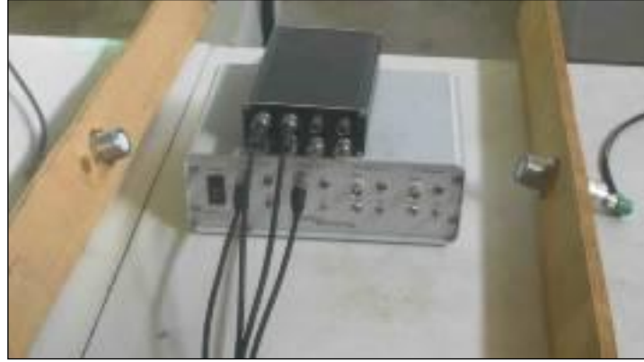
Şekil 7.2 ULS 40-D cihazı ve iki adet USS20130 algılayıcıları (Kişisel arşiv, 2017)
