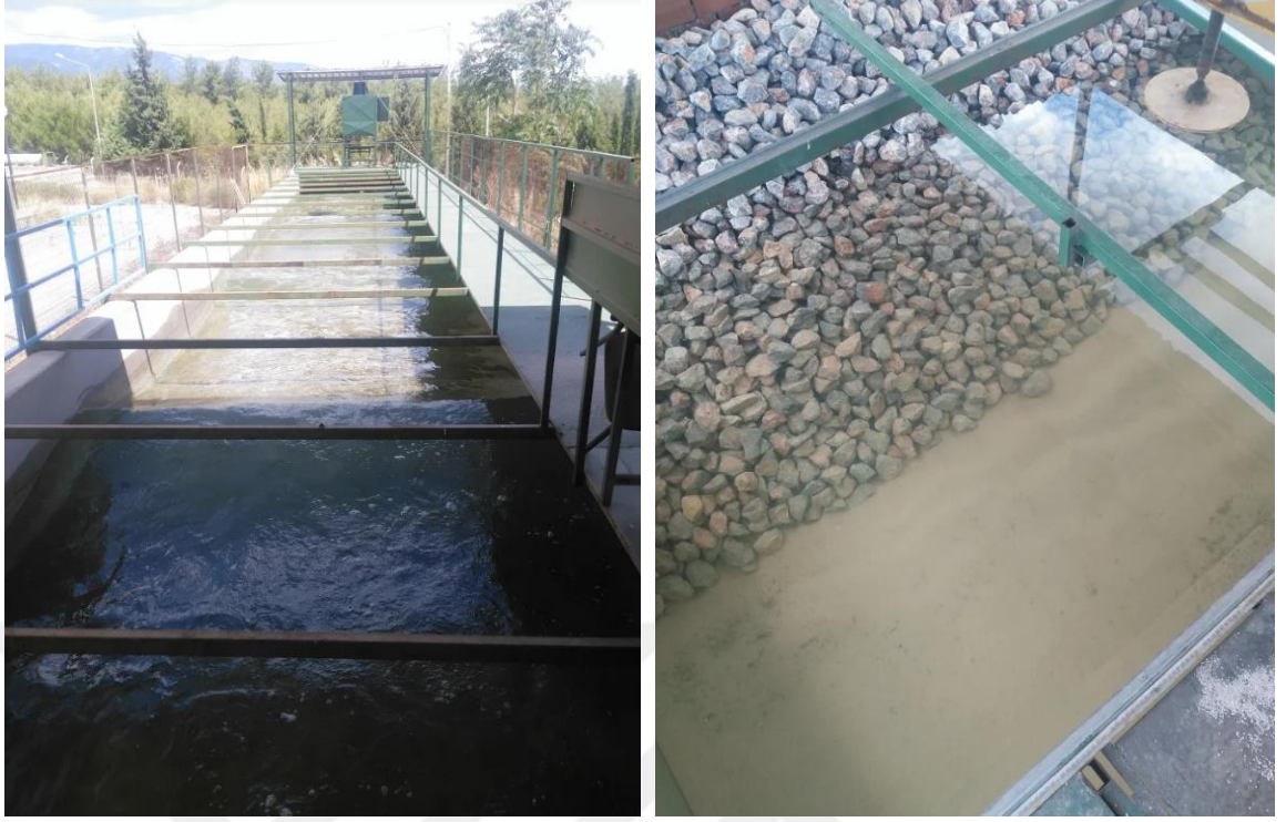
Şekil 7.1 Deneysel çalışmalarda kullanılan dalga kanalının genel görünümü (2:3 şevli oluşturulan deneysel dalgakıran) (Kişisel arşiv, 2017)
