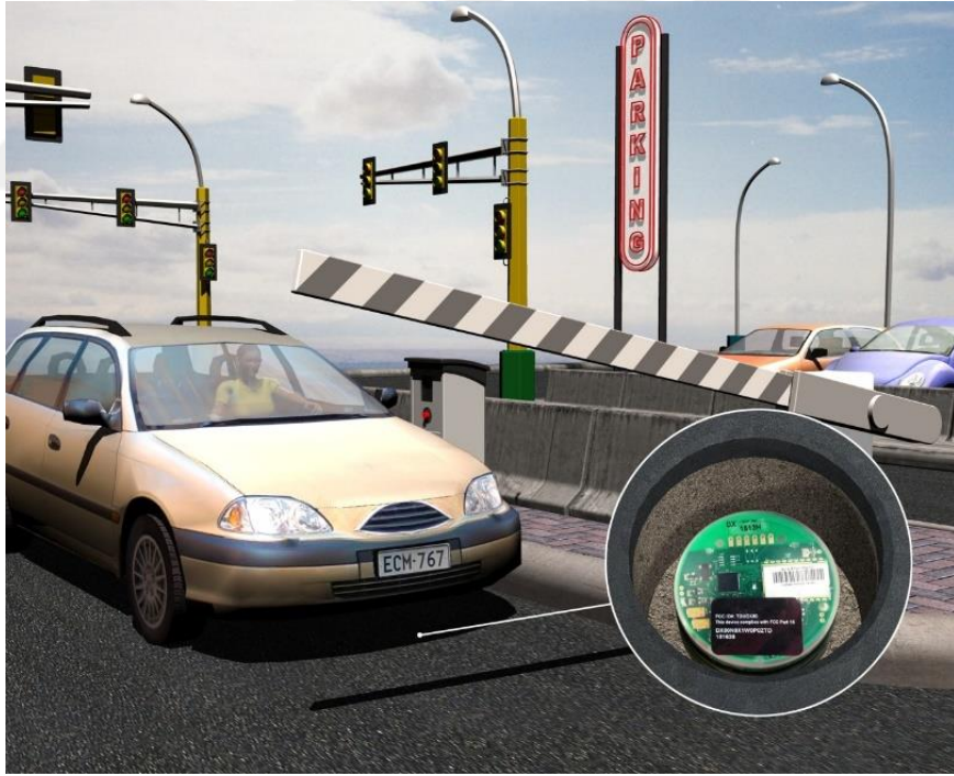
Şekil 2.8 Otopark girişinde magnetometre ile araç sayım uygulaması (Banner, 2019)
