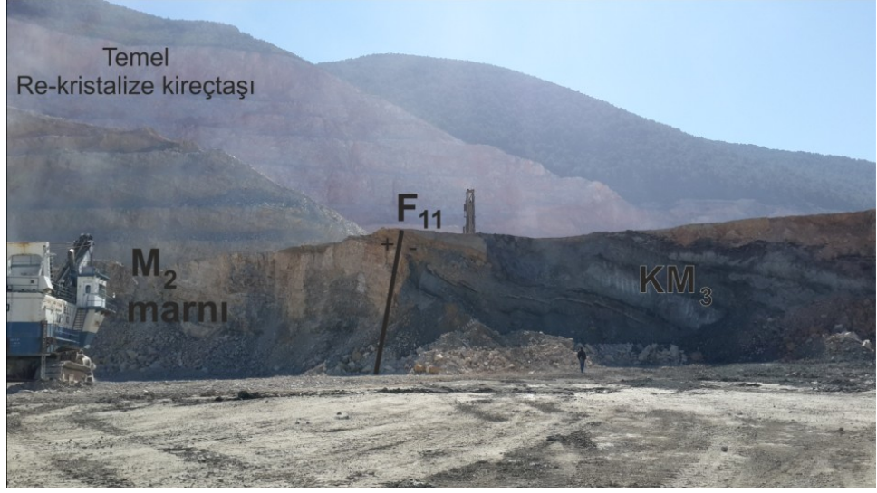
Şekil 3.14 M2 marnı ile KM3 kömürü arasındaki F_{11} fayının görünümü (Kişisel arşiv, 2015)
