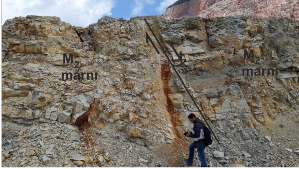
Şekil 3.7 Tektonik etki nedeniyle bol kırıklı ve çatlaklı yapı kazanmış M2-marnları ve içerisinde gözlenen IX-nolu fay zonu (Kişisel arşiv, 2015)
