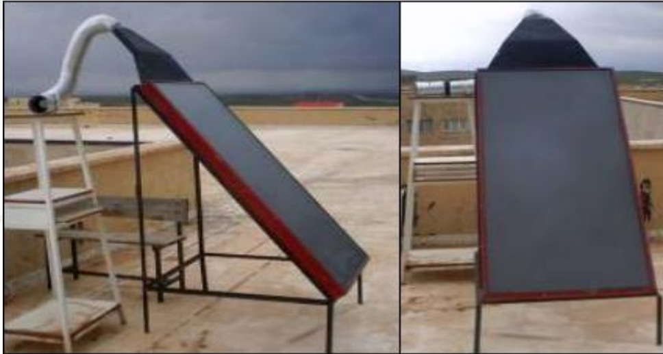
Şekil 2.15 Üretimi tamamlanmış bir havalı güneş kolektörünün dış görünüşü (Bulut ve Durmaz, 2006)
