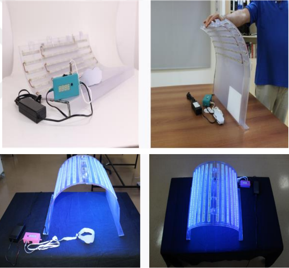
Şekil 1.20 LED lambalı ev tipi fototerapi cihazı (Yılmaz ve diğer., 2015)
