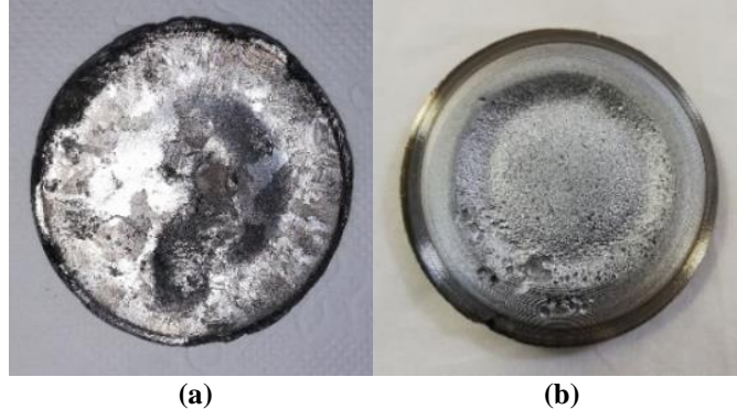
Şekil 2.9 Miknatıssal saçtırma sisteminde kullanılan hedefler (a) NiMnSnB (B2); (b) NiTi (C) (Kişisel arşiv, 2019)
