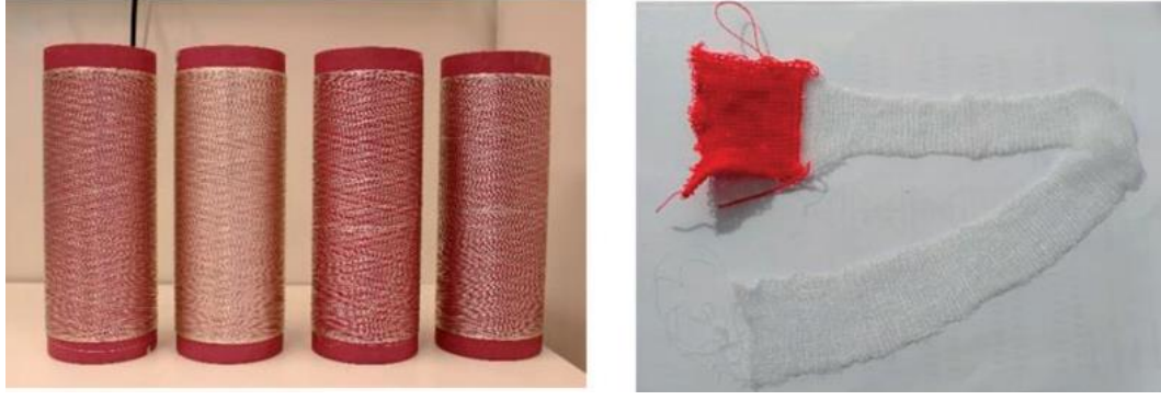
Şekil 1.22 Üretilen şekil hafızalı poliüretan iplik ve kumaş (Saenz-Perez ve diğer., 2019)
