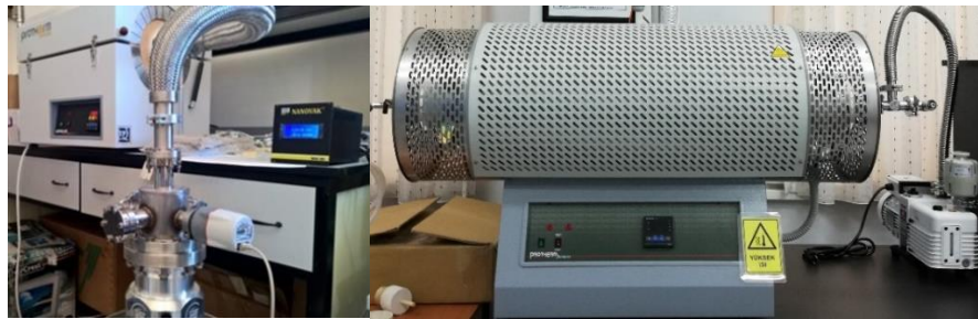
Şekil 2.10 Isıl işlemde kullanılan vakum düzenekli tüp fırınlar (Kişisel arşiv, 2017)
