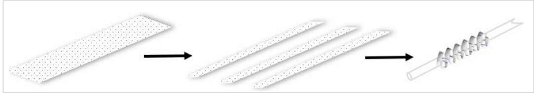
Şekil 2.14 Kompozit film yapılarından şekil öğretme aşamaları şematik gösterimi
