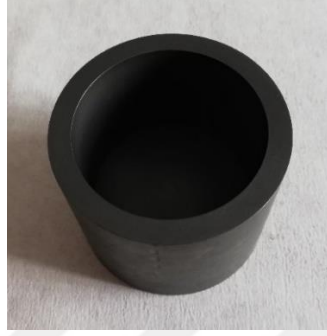
Şekil 2.2 İndüksiyon ergitme sisteminde alařım üretimi için kullanılan grafit pota (Kişisel arşiv, 2019)
