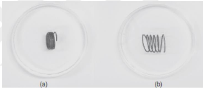
Şekil 1.27 NiTi yayın sıcaklık ile şekil değişimi (a) vücut sıcaklığında (34 °C) sıkı hali; (b) yüksek sıcaklıkta ( T > 50 °C) veya düşük sıcaklıkta ( T < 10 °C) genişlemiş hali (Kim, 2014)
