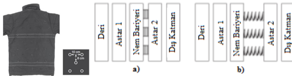
Şekil 1.28 SMA yayların kumaşlar arasındaki yerleşimi (a) vücut sıcaklığında; (b) yüksek sıcaklıklarda meydana gelen etki (Kim, 2014)
