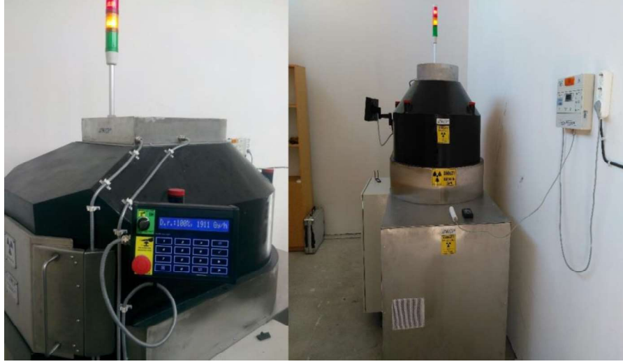
Şekil 3.10 Işınlama işlemlerinde kullanılan deneysel ^{60}\text{Co} gama ışınlama kaynağının genel görünümü (TAEK, 2018)
