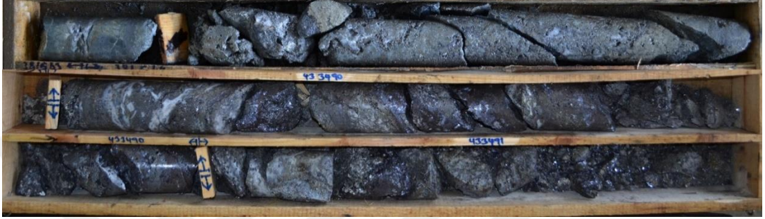
Şekil 6.6 Baz metal zengini masif sülfid faza örnek HQ çap karot fotoğrafı (Kişisel arşiv, 2019)
