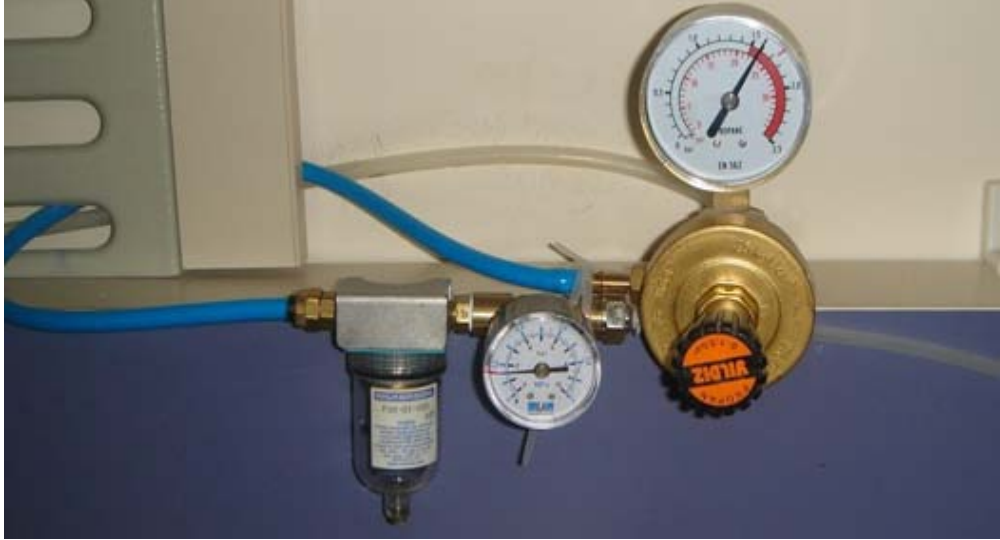
Şekil 4. Basıncı istenilen düzeyde sabit tutmak için oksijen tüpüne ilave edilen gösterge
