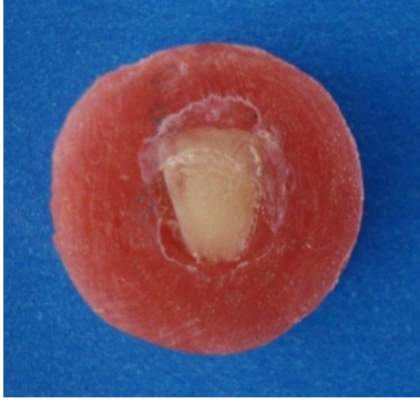
Şekil 20: Mine/Kontrol grubuna ait adeziv kopma örneği
