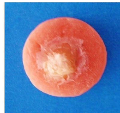
Şekil 25: Dentin/Construct grubuna ait koheziv kopma örneği
