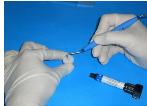
Şekil 7: Teflon kalıp yardımıyla restoratif kompozitin yerleştirilmesi
