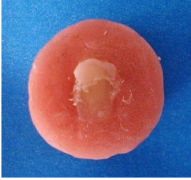
Şekil 22: Mine/Ribbond grubuna ait mix kopma örneği
