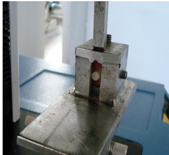
Şekil 13: Örneğin test cihazına yerleştirilmesi ve sabitlenmesi
