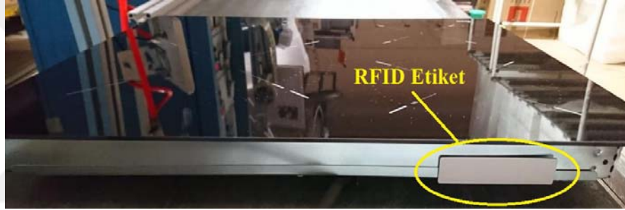
Şekil 39: Üretim Bandı Üzerinde Üretilen RFID Etiketli Ürün
