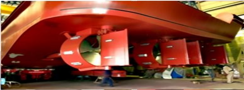
Şekil 17: Kort Nozul Sistemi ile Donatılmış Pervane Sistemi
