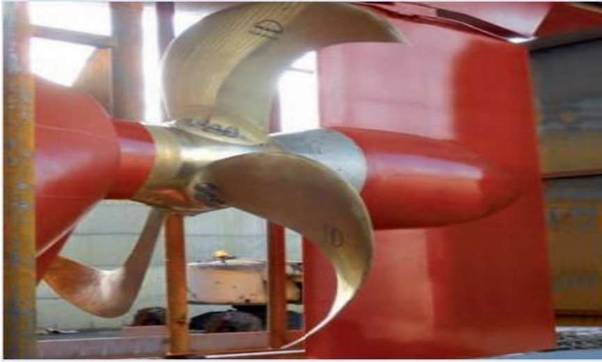
Şekil 12: Entegre edilmiş Bulb İle birlikte Dümen Yelpazesi Örneği
