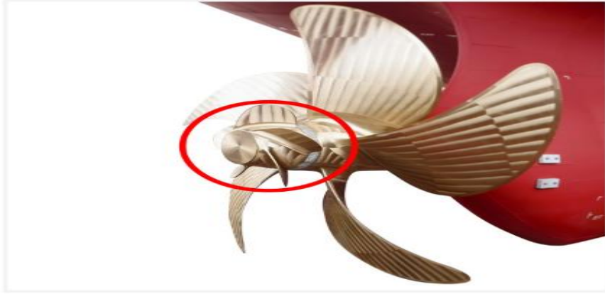
Şekil 13: Propeller Boss Cap Fin (PBCF) Uygulaması Örneği
