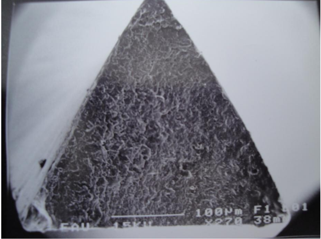
Şekil 33: Kırılan işlemsiz RaCe eğerinin kırık yüzeyi
