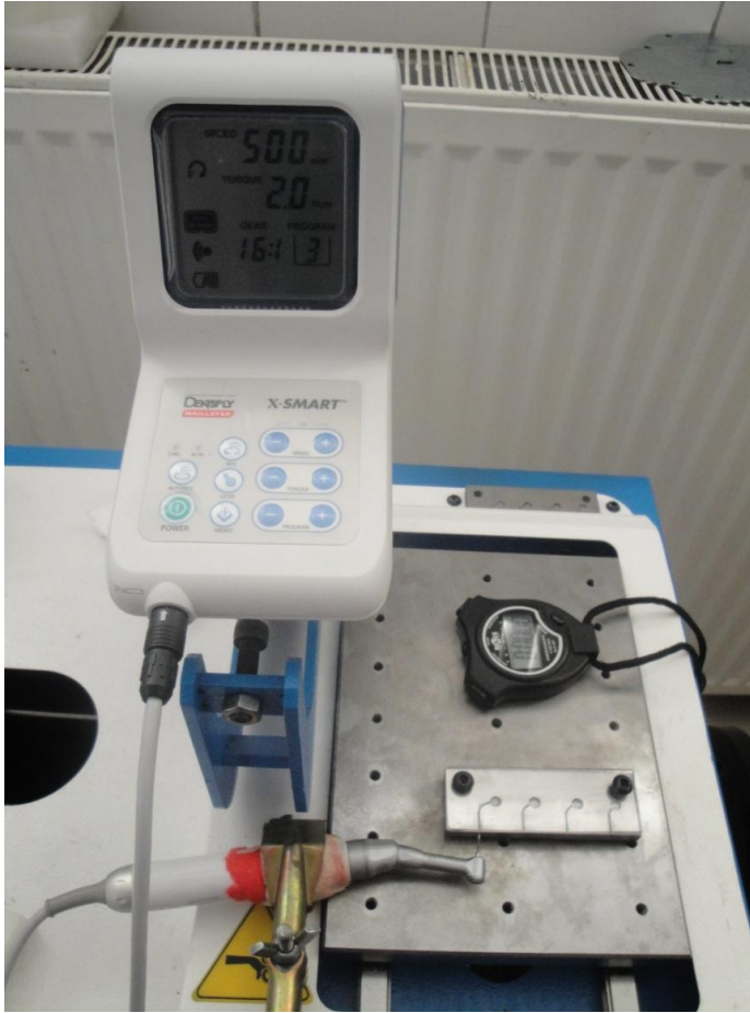
Şekil 21: X-Smart (Dentsply, Maillefer, Ballaigues, İsviçre) tork kontrollü endodontik motor
