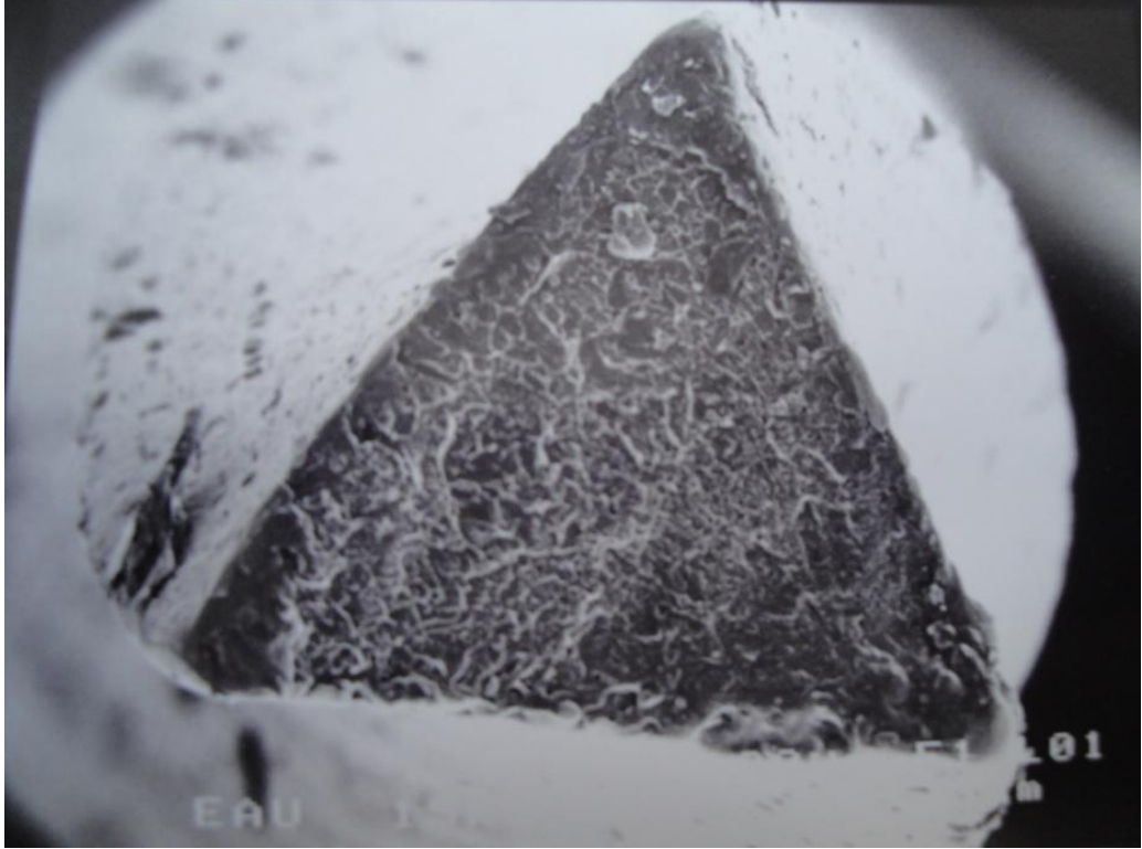
Şekil 38: Kırılan işlemsiz TF eğenin kırık yüzeyi
