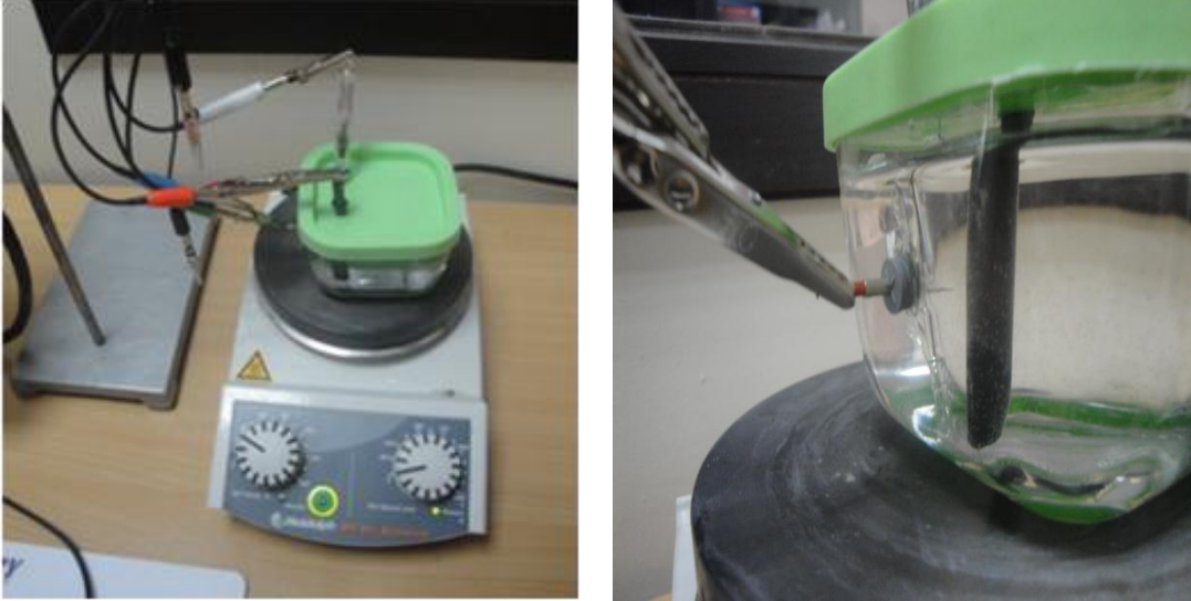
Şekil 24: Cam kap içinde, kanal eğesi, referans elektrot ve karşıt elektrottan oluşan üçlü korozyon ünitesi
