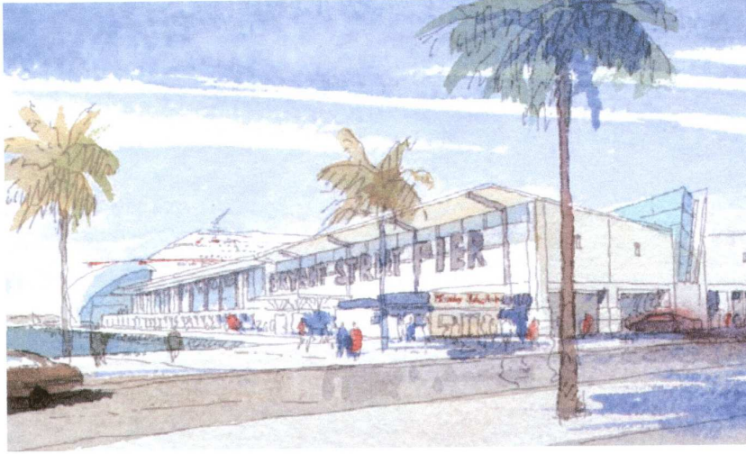
Şekil 6.8. Yolcu gemilerinin yanaştığı terminalin taslağı. Yoğun yaya trafiği için terminalin önünde geniş bir cadde ve alan bırakılmıştır.
