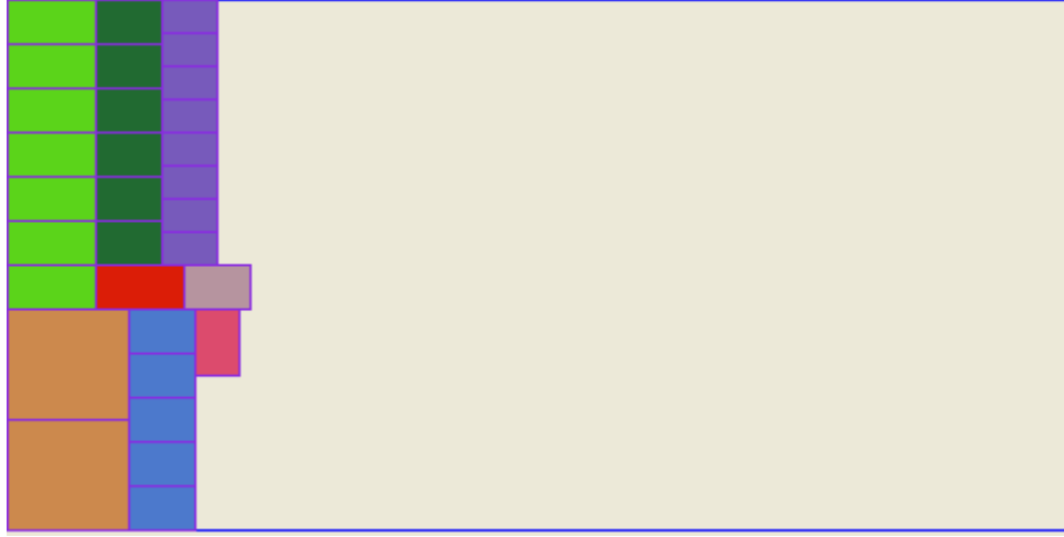
Şekil 3.17 : Tablo 3.8 verilerine göre kalan parçaların üçüncü büyük parça üzerindeki yerleşim planı
