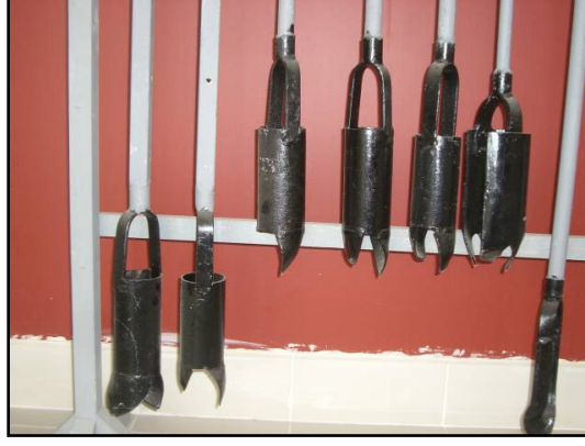
Şekil 5.32 : Sonda ve burgular
