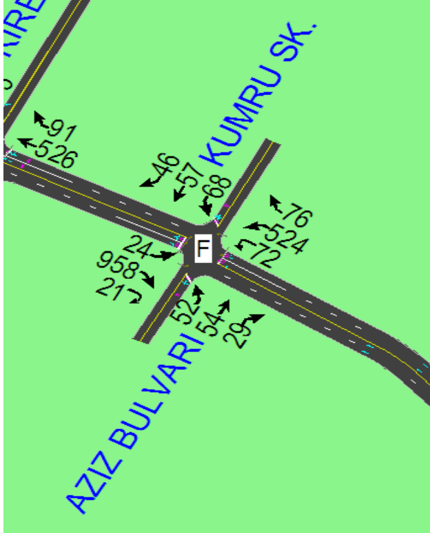
Şekil 7.90: Tavukçuyolu Caddesi&Kumru Sokak&Aziz Bulvarı kavşağı mevcut ve sinyalizasyon yapılmış durum Syncro görünüşü kavşağı
