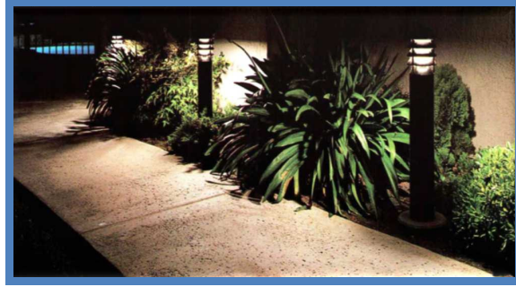
Şekil 3.11: Yürüyüş yolu ve bitki aydınlatmasına uygun armatürlerle aydınlatma örneği (Anonymous, 1993).
