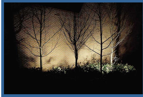
Şekil 5.10: Siluet tekniği kullanılarak yapılan aydınlatma örneği
