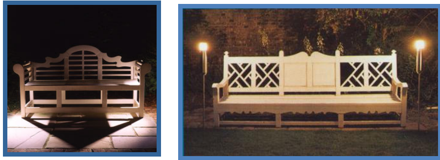
Şekil 5.7: Aşağıdan Yukarıya doğru ve kenardan aydınlatma tekniğinin birlikte kullanım örneği
