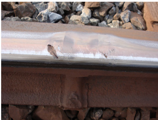
Şekil: 8.7 Dolgu kaynaklı çatlak kaynak
