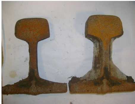
Şekil 8.3: AT kaynak HAZ kırığı Şekil 8.4: Ray mantarında kırıklar
