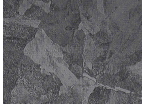
Şekil 8.19: Kaynak mikro yapısı 500X
