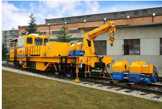
Şekil 4.1 Seyyar gaz basınç kaynak makinesi
