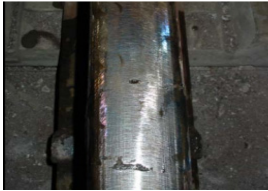
řekil 5.4: Kaynakta kum kalıntısı
