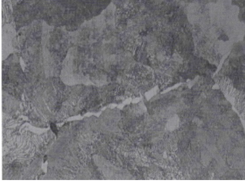
Şekil 8.18: Kaynak mikro yapısı 100X
