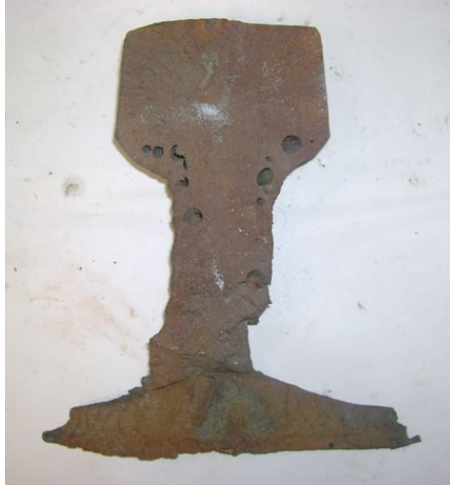
Şekil 8.5: Ray tabanında kırıklar
