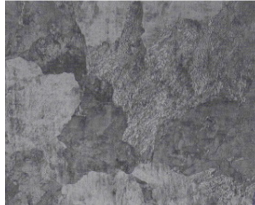
Şekil 8.17: Taban mikro yapısı 500X
