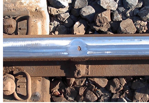
Şekil 8.1: AT kaynağında gözenekler Şekil 8.2: AT kaynağında oyulma
