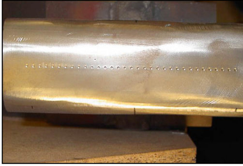
Şekil 6.1: Sertlik ölçme noktaları
