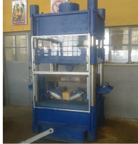
Şekil 6.5: Eğme test makinesi
