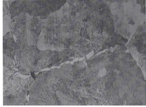
Şekil 8.28: FBW Mikro yapı görünümü
