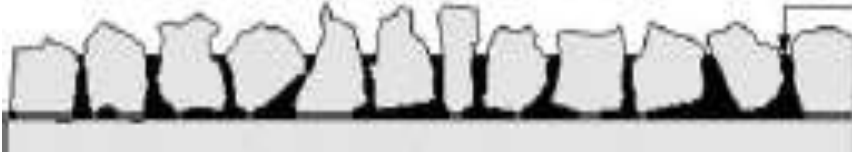
Şekil 2.1 : Tek kat sathi kaplama kesiti
