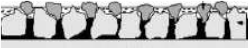
Şekil 2.2 : Çift kat sathi kaplama kesiti
