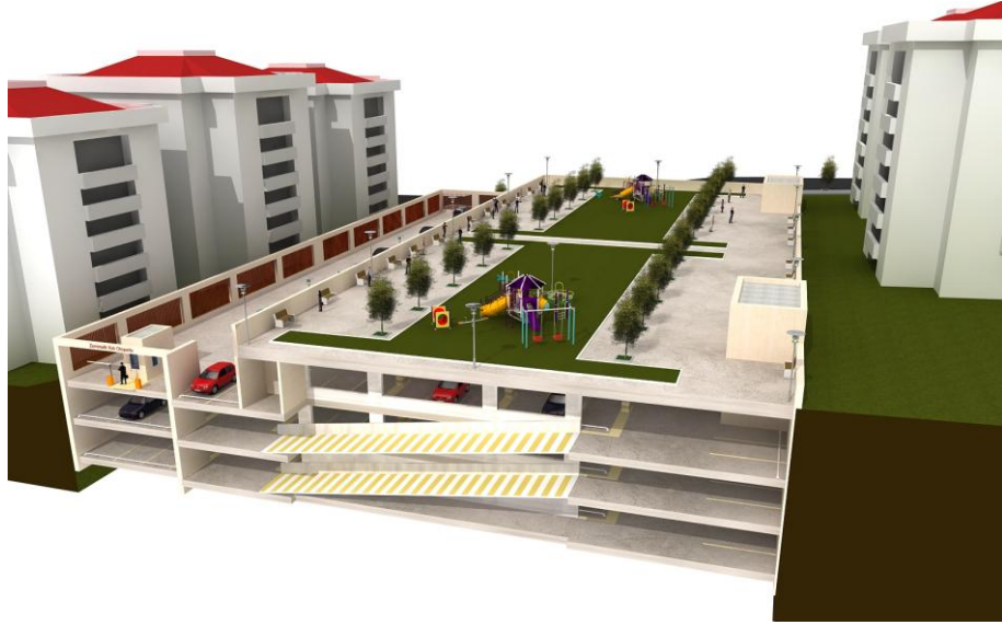
Şekil 2.67: Bağcılar İlçesi, Yenimahalle Mahallesi Site Sokak - Manolya Sokak arası (3204 ada 2 parsel, 2210 parsel, tescilsiz alan) alanına ait zemin altı otopark üzeri park projesinin kesit görünüşü
