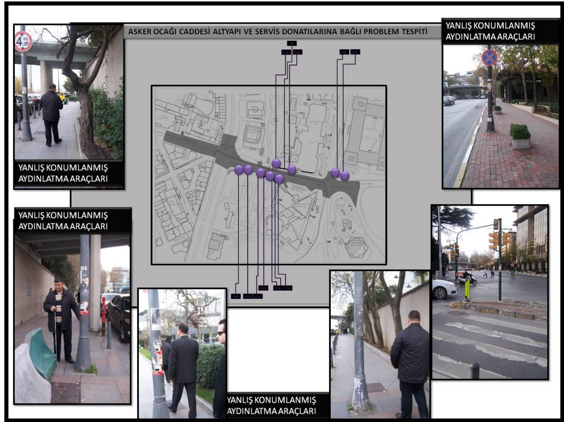
Şekil 6.12 : Asker Ocağı Caddesinde Bulunan Altyapı ve Servis Donatılarına Bağlı Problemler
