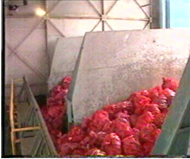
Şekil 5.6. Tıbbi atıkların titreşimli konveyöre aktarılması Kaynak: İSTAÇ AŞ. (2011) Tıbbi Atıkların İnsinerasyon Sunumu
