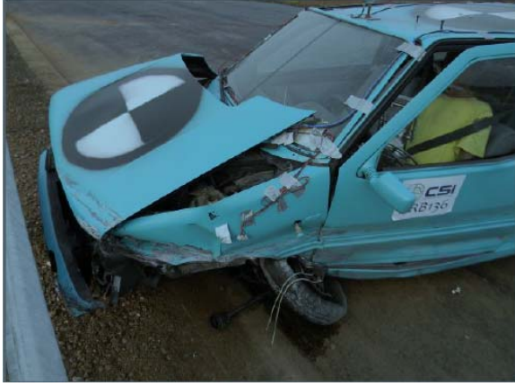
Şekil 4.8: Çarpışma sonunda araçların ve otokorkulukların durumları (CSI, 2012)
