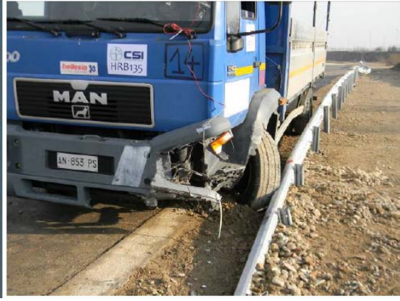
Şekil 4.8: Çarpışma sonunda araçların ve otokorkulukların durumları (CSI, 2012)
