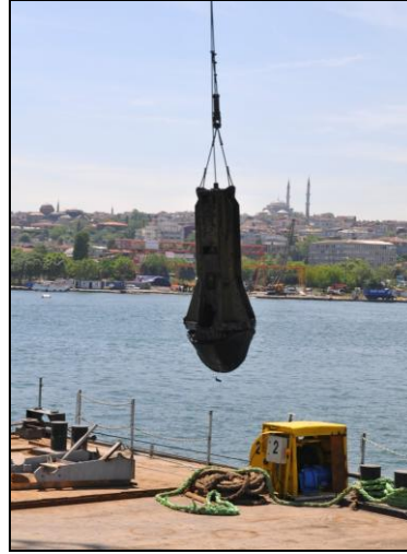
Şekil 5.51: Kazık içindeki yumuşak malzemenin alınmasında kullanılan kaşık.
