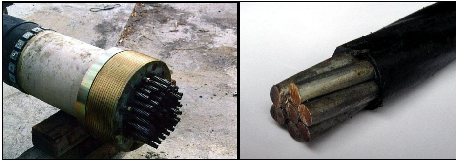
Şekil 2.11: Demetlenmiş kablo demeti ve grup halinde kullanılması.
