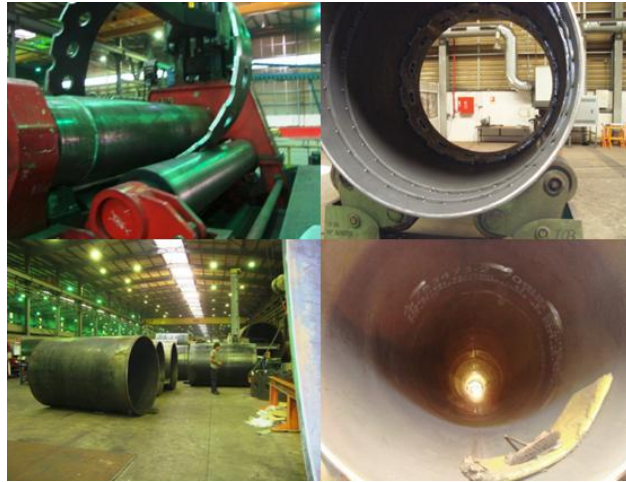
Şekil 5.40: Çelik kazıkların imalat aşamaları.
