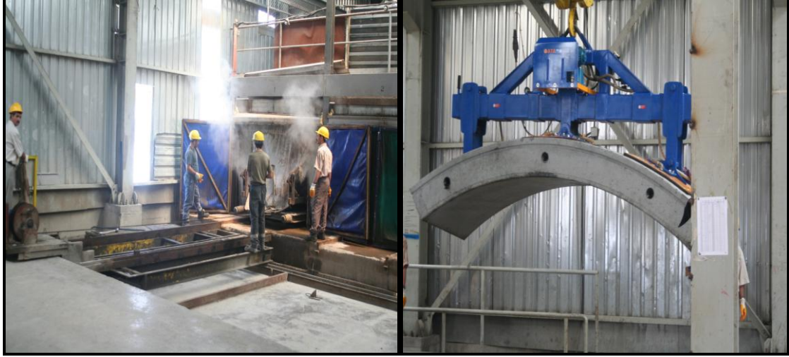
Şekil 2.12: Kalıba Alınan Segmentlere Buhar Kürü Uygulanması
