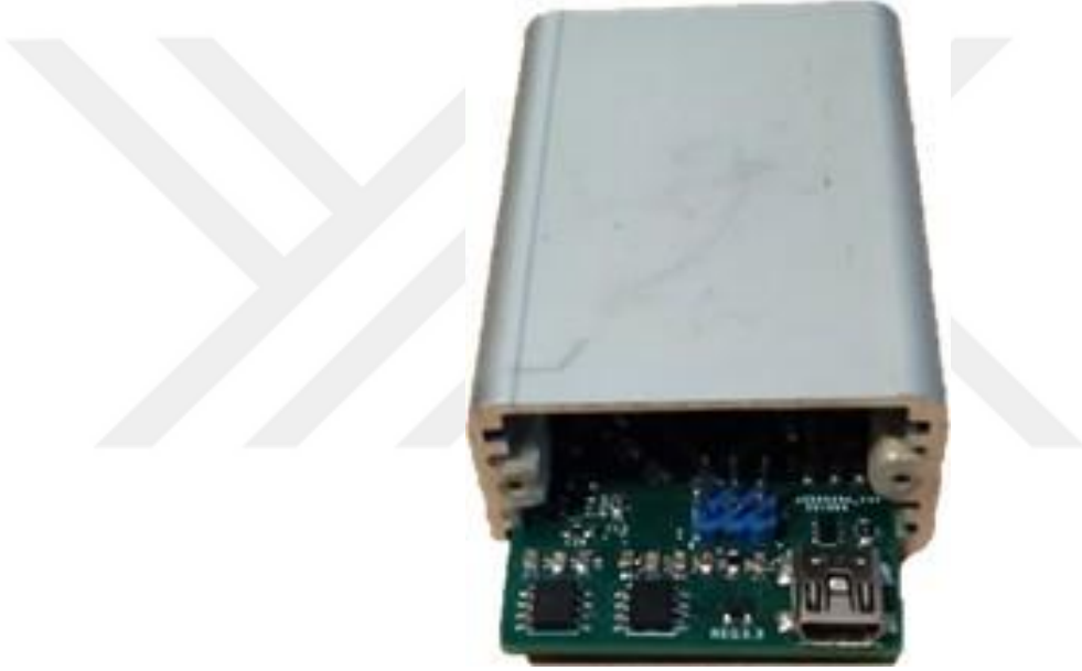
Şekil 3.4. Baskı devre serimi ve üretimi yapılmış 39 mm x 62 mm boyutundaki devre.
