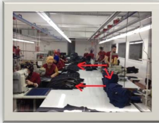
Resim 11. Düzenleme Sonrasında Cebin Dikim İçin İletildiği Mesafe
