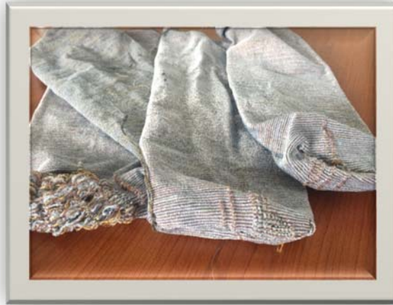
Resim 16. Yıkama Denemesi Sonrası Yıpranan File Örnekleri
