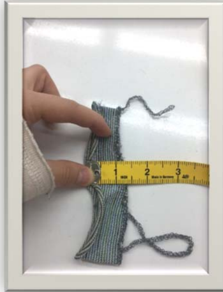
Resim 14. Yıkama Sonrası Kesilmesi Gereken File Miktarı
