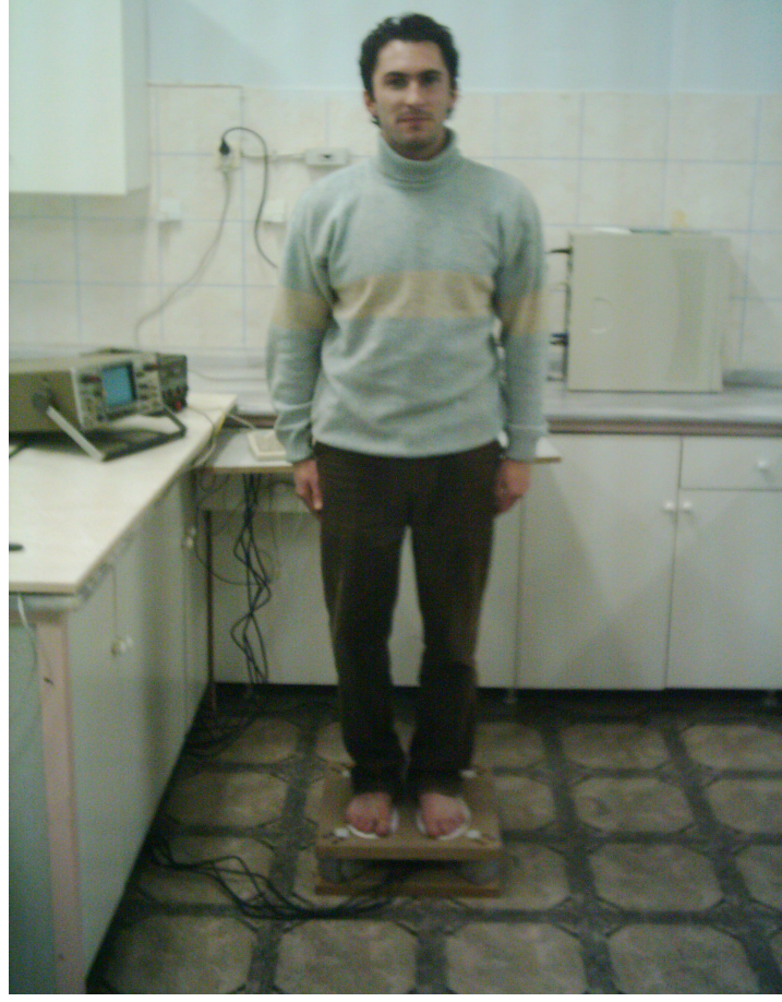
Şekil 3.2. Deneğin güç platformu üzerinde ölçümü
