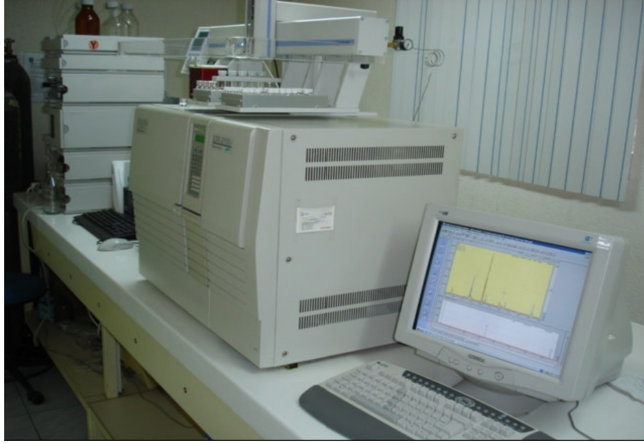
Şekil 3.1. GATA Analitik Toksikoloji Bilim Dalı laboratuvarında kullanılan GC-MS cihazının fotoğrafı.
