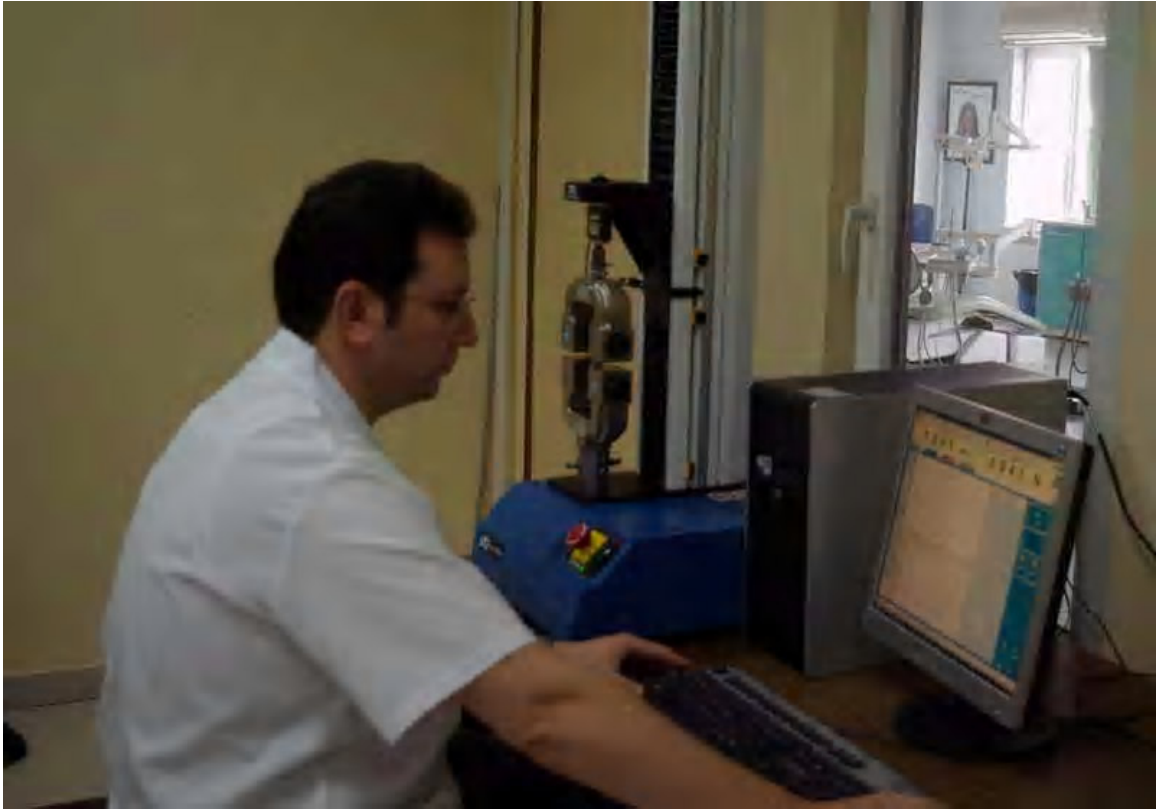
Resim 3. 8. Bilgisayar kontrollü maksimum yükleme kapasitesi 100N olan hassas yük hücresine sahip Instron (Illinois Tool Works Inc. Norwood, Massachusetts, A.B.D.) test cihazı.
