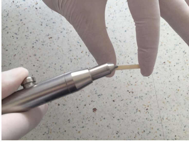
Şekil 3.6. Örneklere CoJet işleminin uygulanması
