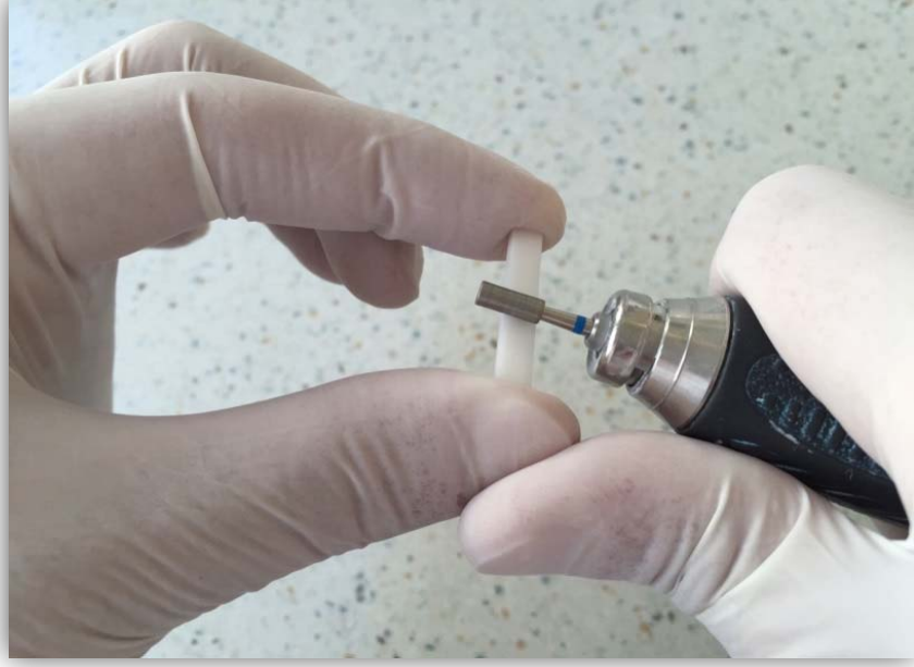
Şekil 3.3. Örnek yüzeylerini aşındırma işlemi
