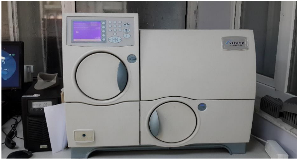
Şekil 3.3. Otomatize bakteri tanımlama sistemi (VİTEK 2®)
