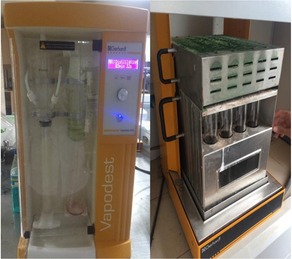
Şekil 3.3. Ham protein yağ yakma ve destilasyon üniteleri cihazı
