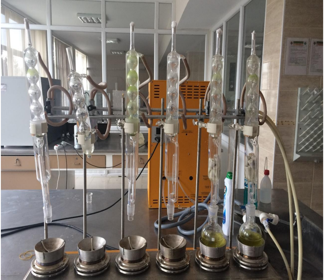
Şekil 3.2. Soxhlet cihazında ham yağ analizi
