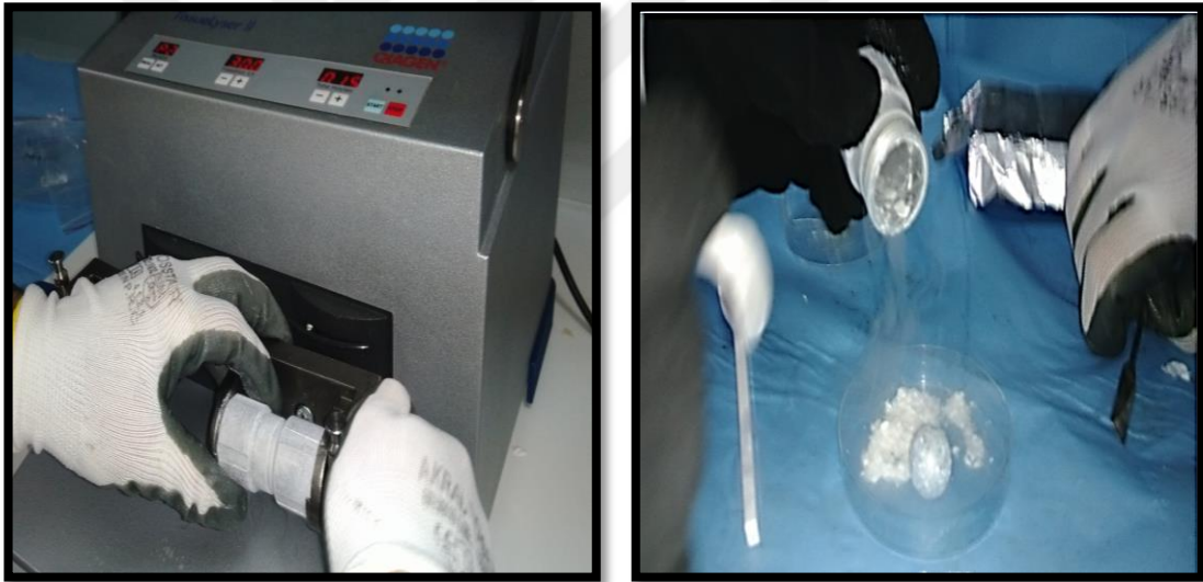
Şekil 3.1. Deneyde kullanılan doku homojenizatörü ve bilyeli öğütücü
