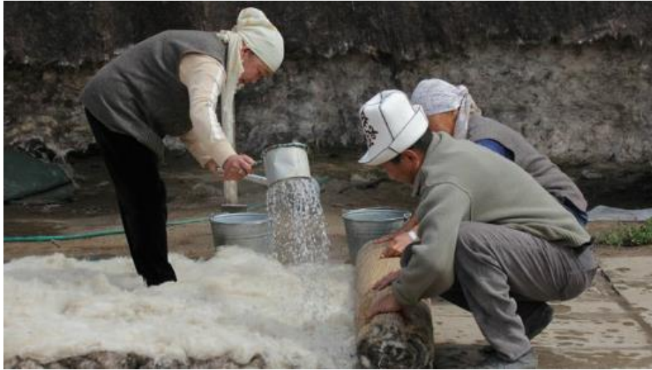
Fotoğraf 3.10. Su Kabı İle Suyun Serpilmesi
