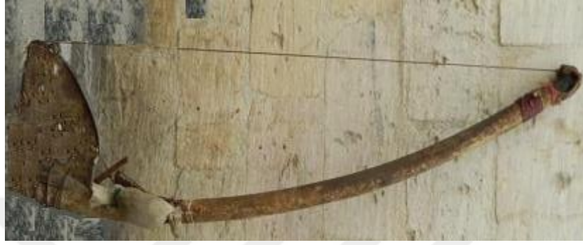
Fotoğraf 3.6. Yaylıtokmak, Eski Y ntemle Y n  D zeltme Aracı (Y z g ld 'den)
