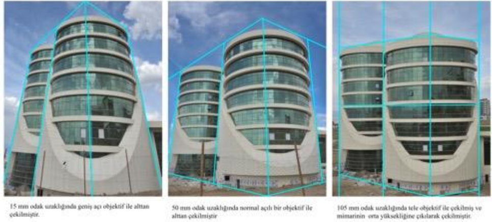
Fotoğraf 60. Objektif odak uzunluğu ve farklı bakış açılarından oluşturulan perspektif etkisi.
