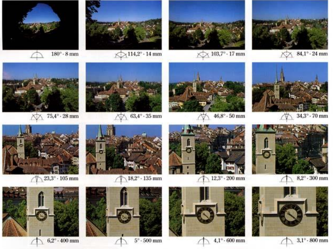
Fotoğraf 52. Geniş açıdan dar açılı objektiflerin görüş mesafesi.
