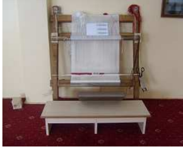
Resim 53: Dikey Düz Tezgah (Germe Tezgah-Küçük Tip)
